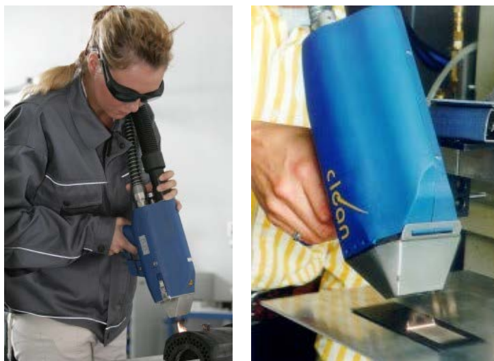
Рис. 35. Лазерная очистка поверхности с помощью ручной головки
