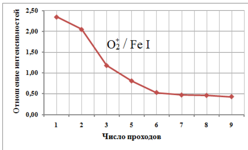
Рис. 50. Зависимость отношения интенсивности линии кислорода ( O_2^+ - 588,86 нм) к линии железа ( Fe I - 558,61 нм) от числа проходов лазерного излучения.
