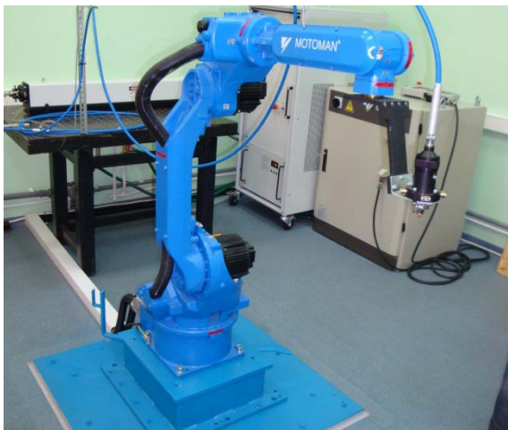
Рис. 30. Лазерная очистка памятников культуры : а - роботизированный комплекс для обработка поверхностей сложной формы (НИУ ИТМО), б - скульптуры (Елисеевский магазин, Санкт-Петербург)
