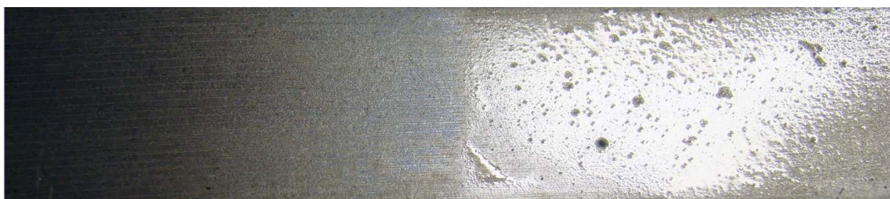
Рис. 11. Очистка стальной полосы от масляной пленки (слева—очищенная часть). Использован волоконный лазер со следующими параметрами : мощность 50Вт, частота импульсов 100 кГц, диаметр луча в зоне обработки 0,1 мм. Производительность 100 м 2 /ч.
