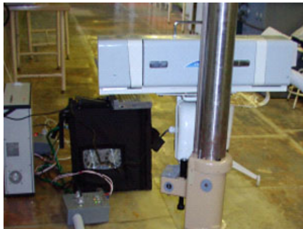
Рис. 22. Мобильный комплекс для дезактивации: а- излучатель с AIG-лазером, системой сканирования, на управляемой поворотной платформе, б- комплекс в сборе: излучатель, система охлаждения, источник питания
