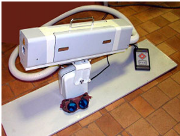
Рис. 22. Мобильный комплекс для дезактивации: а- излучатель с AIG-лазером, системой сканирования, на управляемой поворотной платформе, б- комплекс в сборе: излучатель, система охлаждения, источник питания
