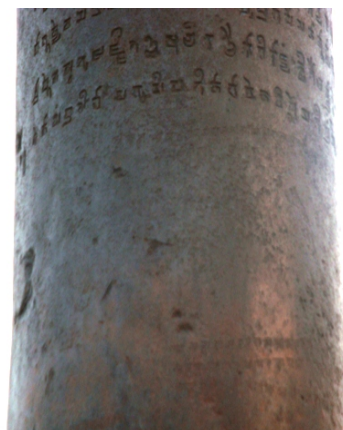
Рис. 28. Вид поверхности с антикоррозионными свойствами: а- поверхность трубы из стали 38Г2С после лазерной обработки, в- поверхность нержавеющей колонны (Индия)
