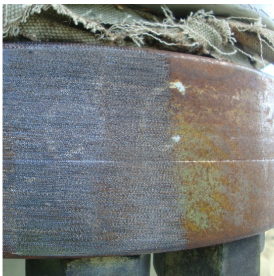
Рис.54. Практические примеры высокоэффективного применения лазерной очистки поверхности: очистка фланцевых соединений от ржавчины взамен пескоструйной технологии
