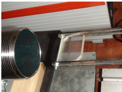
Рис. 12. Очистка окалины с внутренних поверхностей насосно-компрессорных труб: а - стенд для очистки, б - очищенная внутренняя поверхность трубы
