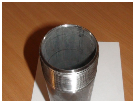
Рис. 12. Очистка окалины с внутренних поверхностей насосно-компрессорных труб: а - стенд для очистки, б - очищенная внутренняя поверхность трубы
