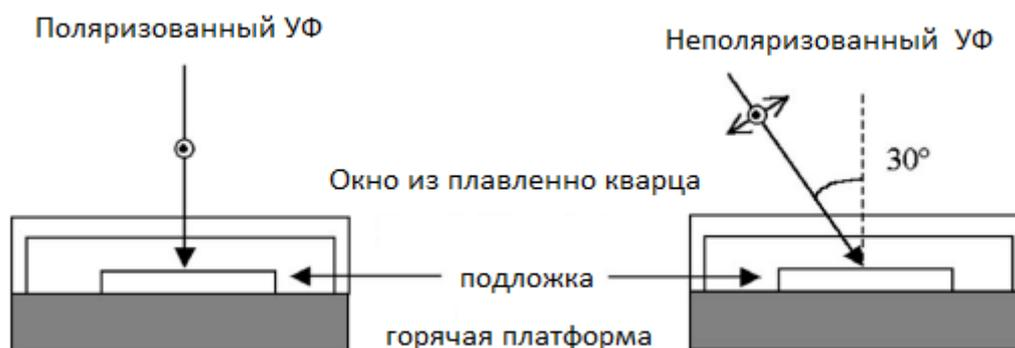
**Рис. 47.** Схема двухступенчатого процесса имидизации с помощью УФ излучения [49].
