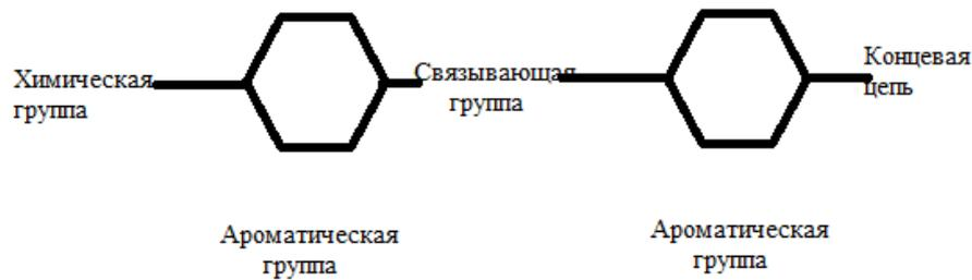
Рис. 2. Схематическая структура молекулы нематического жидкого кристалла.
