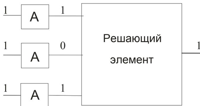
Рис. 5.6. Мажоритарное резервирование
