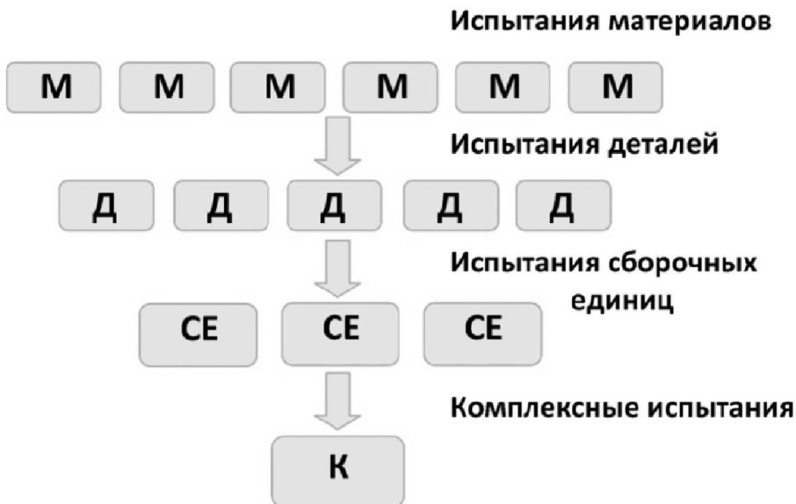
Рис. 2.2 Структура типовой иерархии испытаний
