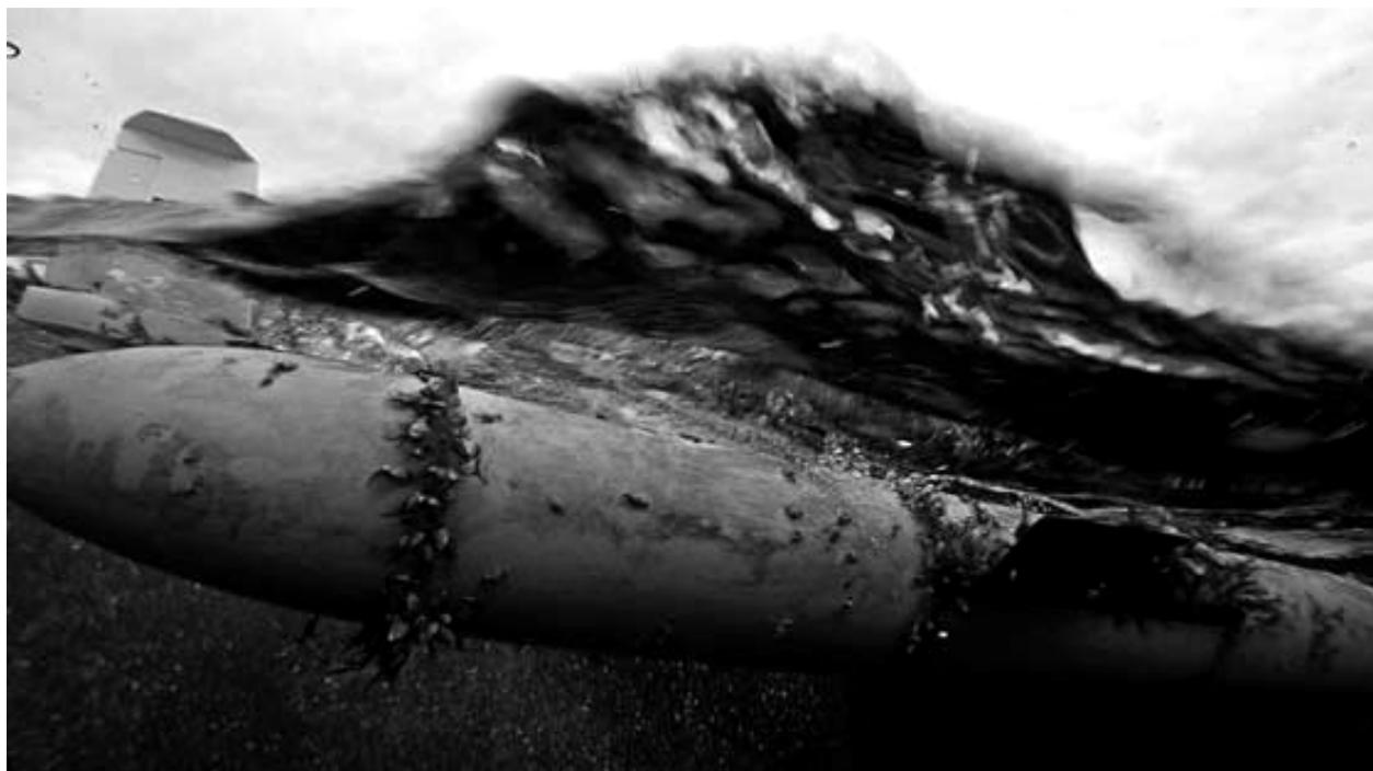
Рис. В.1 Внешний вид НПА Scarlet Knight после длительного пребывания в морской воде
