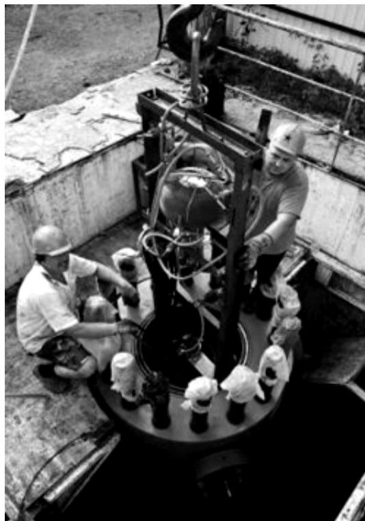
Рис. 6.3 Спуск в камеру пространственной рамы с закрепленными на ней испытываемыми элементами движительно-рулевого комплекса АСА «Бестер»
