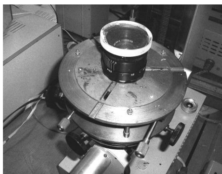
Рис.7. Контроль объектива Гелиос-44 на интерферометре Физо
