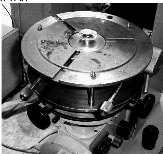
Рис.3. Контроль линзы на интерферометре Физо
