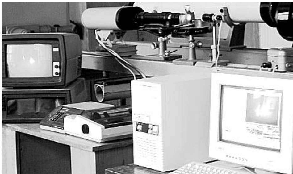
Рис. 5 Общий вид установки для компьютерной изофотометрии ФРЛ
