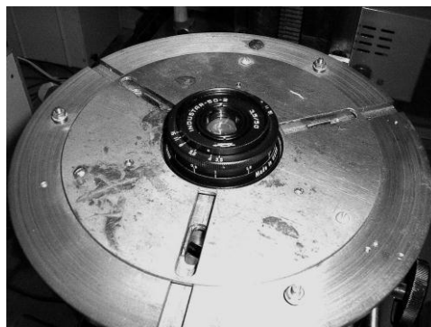
Рис. 9. Объектив Индустар-50 на интерферометре Физо
