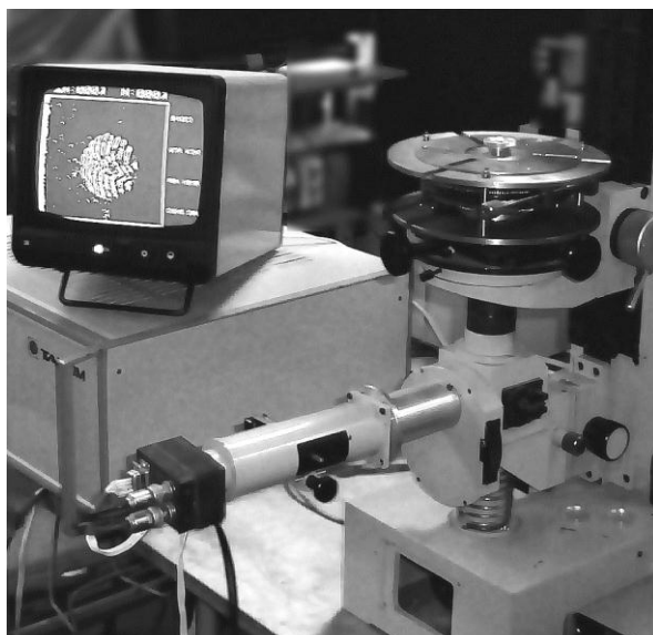
Рис. 4. Общий вид интерферометра Физо в агрегате с анализатором интерферограмм ТАИ-1 при контроле линзы
