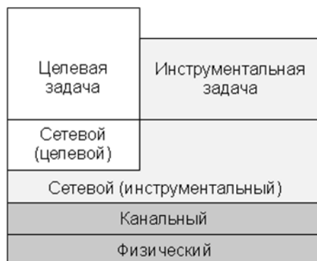
Рис. 2.40. Инкапсуляция целевой КМС в инструментальную
