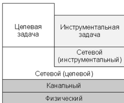
Рис. 2.39. Инкапсуляция инструментальной КМС в целевую
