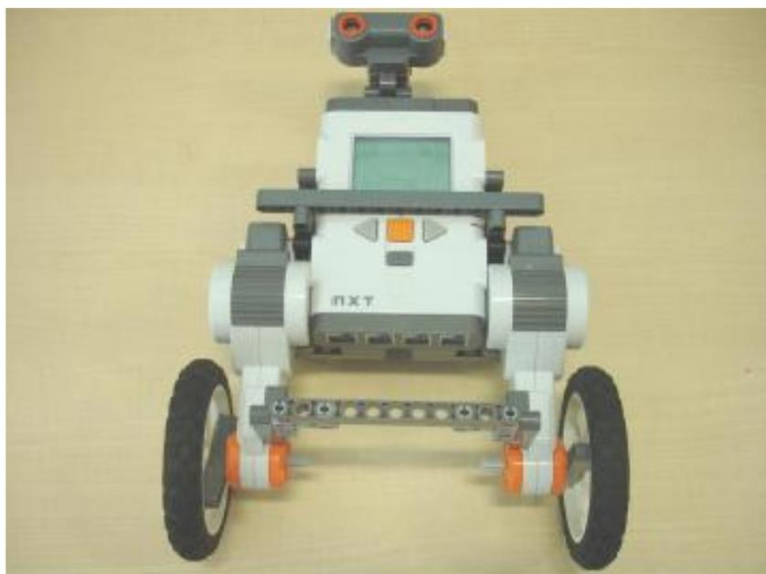
Рисунок 1.46 - Балансирующий робот «Segway»
