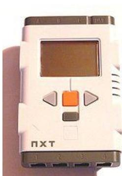
Рисунок 1.1 – Программируемый контроллер NXT компании LEGO
