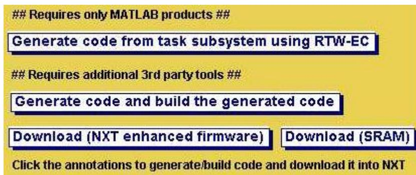
Рисунок 1.12 – Кнопки в Simulink-модели для генерации, компиляции и загрузки С-кода в контроллер NXT
