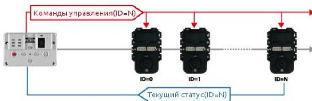
Рисунок 2.7 – Управление сервоприводами Dynamixel посредством микроконтроллера CM-510
