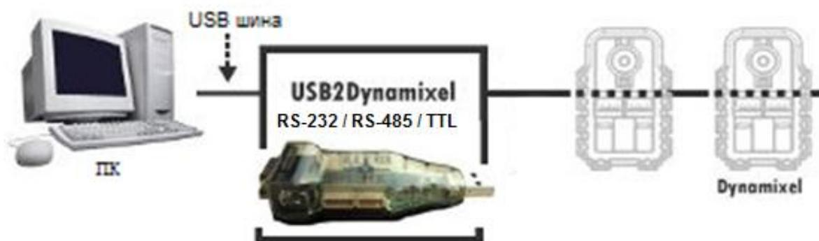
Рисунок 2.8 – Поддержка протоколов RS-232 и RS-485 управляющей электроникой сервоприводов Dynamixel
