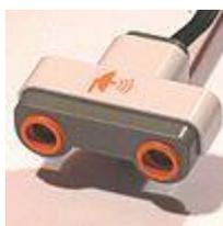
Рисунок 1.2 – Датчик расстояния
