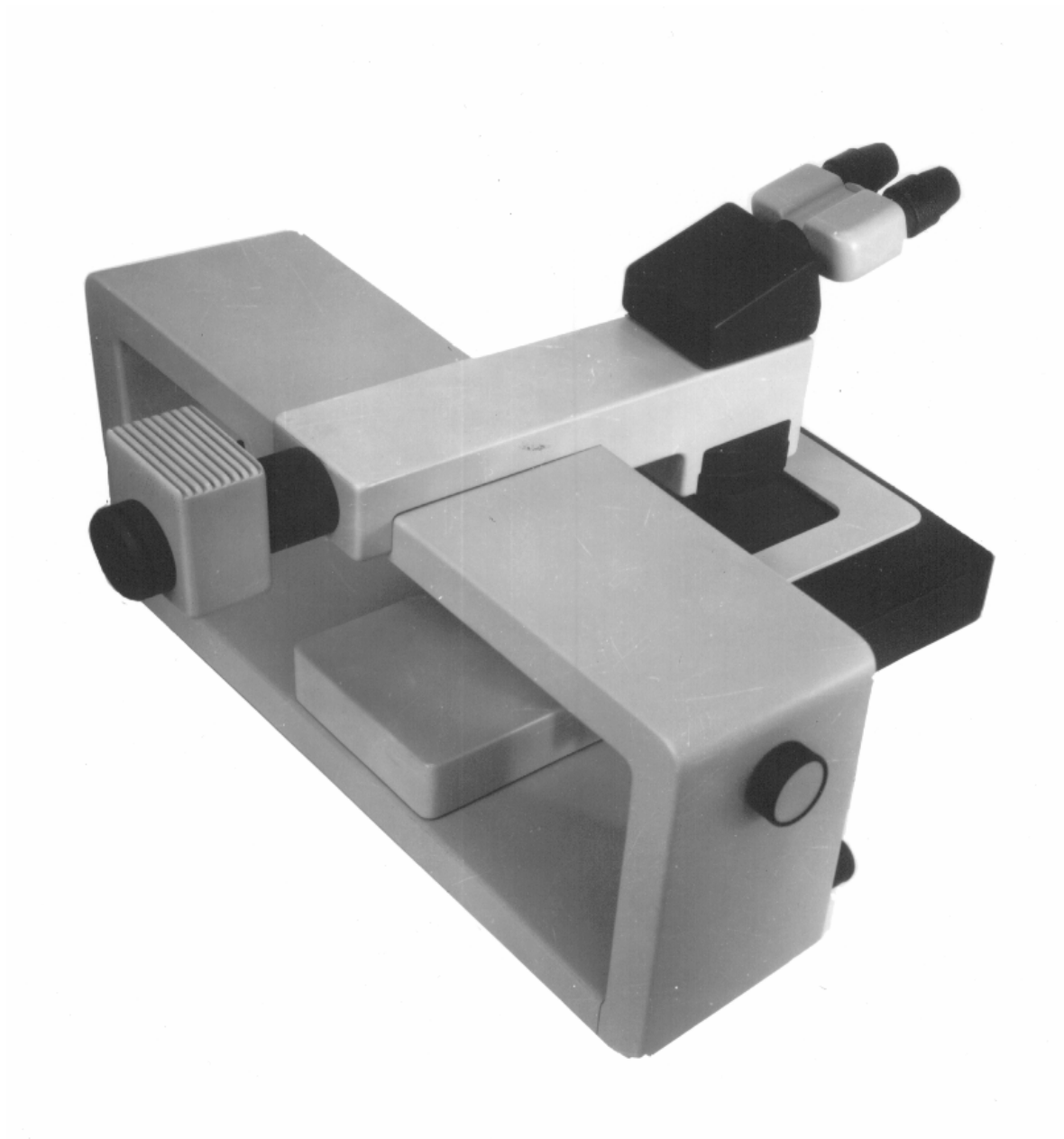
Рис. 1.7. Макет компонентки прибора для контроля микросхем
