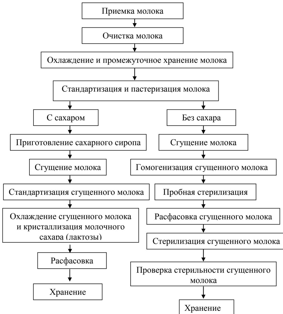
Схема 16. Общая технологическая схема производства молочных консервов
