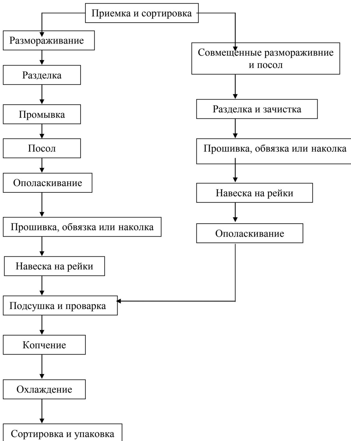
Схема 9. Технологический процесс горячего копчения рыбы
