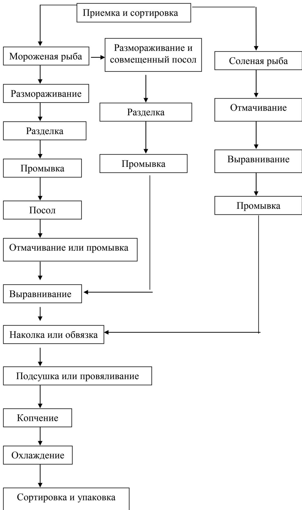
Схема 8. Технологический процесс холодного копчения свежей и соленой рыбы
