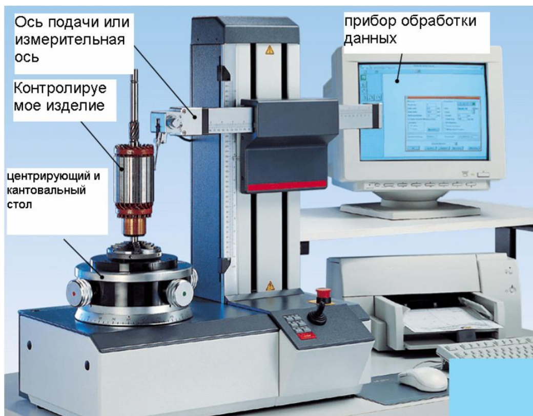
Рис. 9.17 Установка для измерения и контроля геометрических характеристик цилиндрических поверхностей
