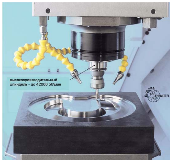
Рис. 3.18 Процесс фрезерования концевой фрезой сложного контура
