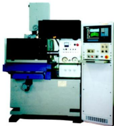
Рис.5.4 Электроэрозионный 5-ти координатный проволочный вырезной станок с ЧПУ мод. СКЭ250Ф5
