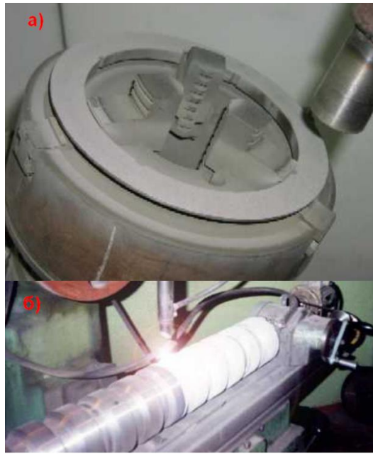
Рис.10.15 Виды напыленных поверхностей, производимые с помощью представленного на рис.10.2 оборудования: а- напыление торцовых уплотнений; б – напыление роликов
