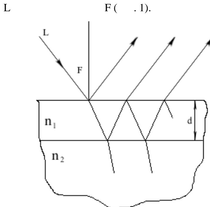
Рис. 1. Ход лучей в тонкой плёнке при наклонном
