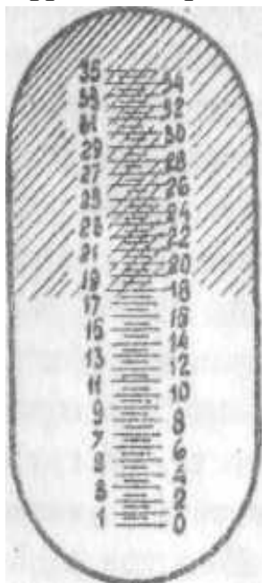
Рис. 2. Вид поля зрения рефрактометра модели RR 12. Разграничительная линия указывает 17,5 %
