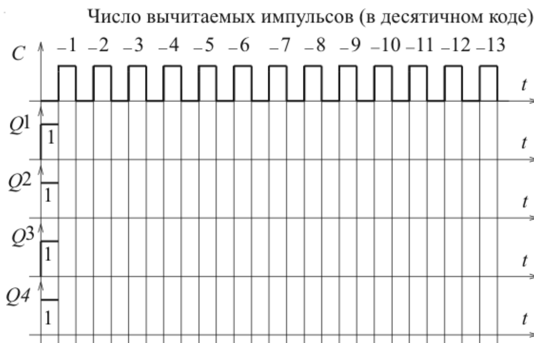
Рис. 7.10. Экспериментальные временные диаграммы в двоичном вычитающем счетчике с последовательным переносом
