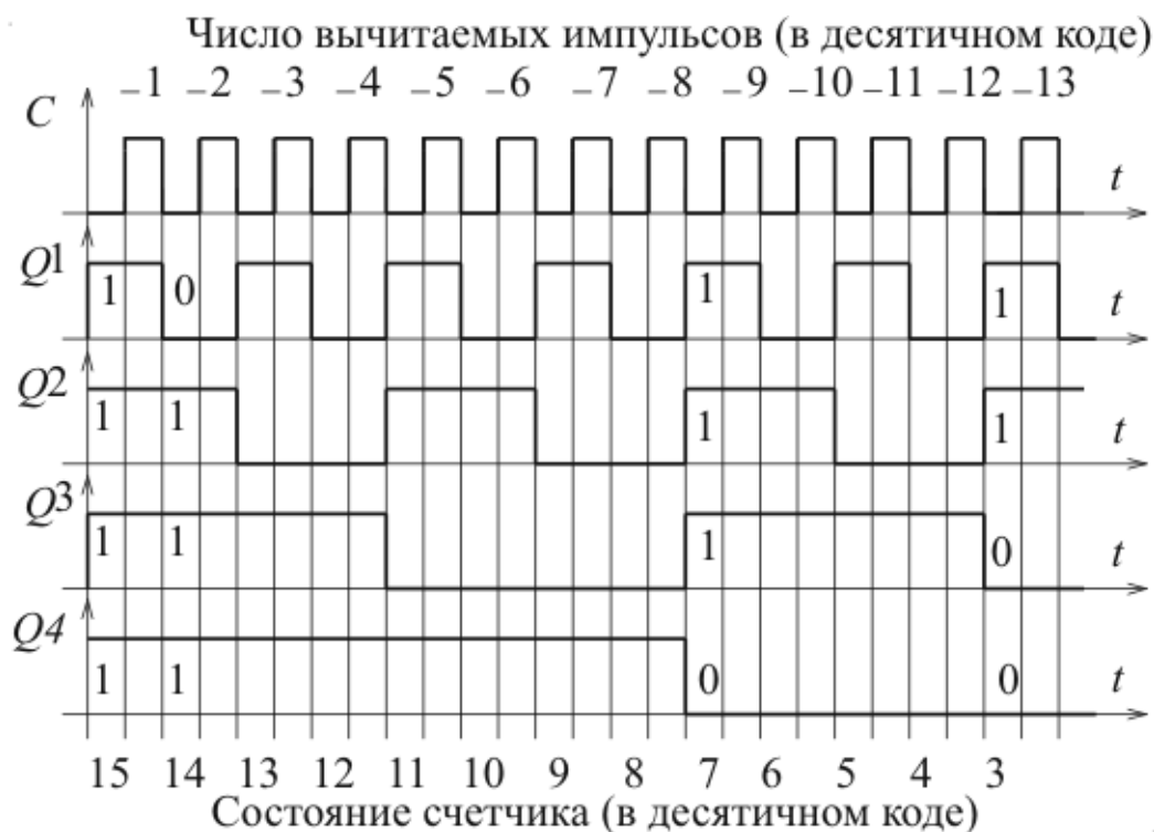
Рис. 7.4. Временные диаграммы в вычитающем двоичном счетчике с последовательным переносом
