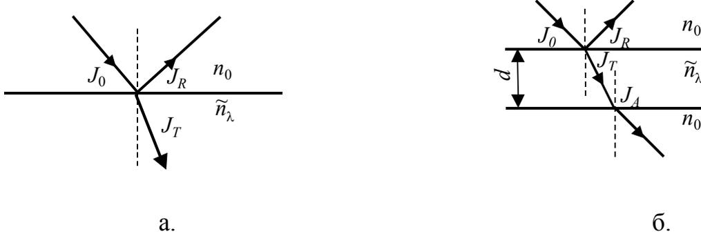
Рис.37. Распространение света в плоскопараллельной пластине вторую границу раздела  $J_A$ . Тогда в соответствии с законом Бугера:
