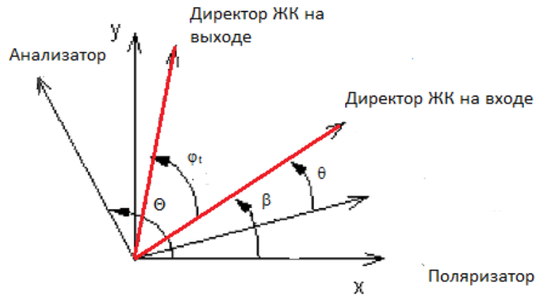
Рисунок 50 - Схематическое изображение расположения директора и легкой оси ЖК между направлениями поляризации света [57].
