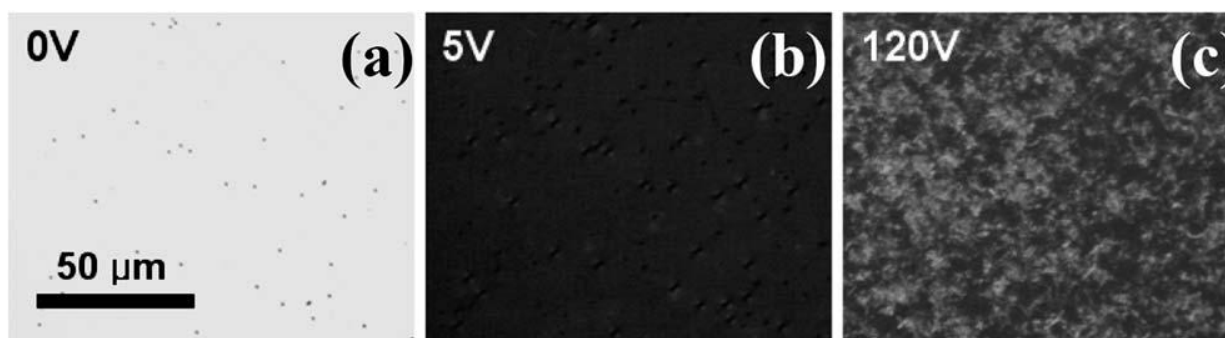
Рисунок 74 - Микрофотографии ячейки, допированной MWNT, в исходном состоянии и при приложении электрического поля напряженностью 1 В/мкм и 26 В/мкм. Пятна, наблюдаемые при 0 В, соответствуют спейсерам [91].
