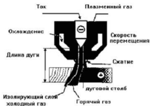
Рис.3.57. Схема плазменной обработки
