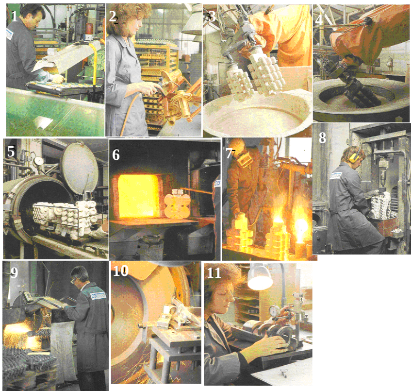
Рис 2.5 Этапы получения заготовок с помощью литья по выплавляемым моделям:
