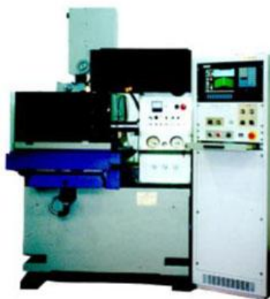
Рис.3.47. Электроэрозионный 5-ти координатный проволочный вырезной станок с ЧПУ мод. СКЭ250Ф5
