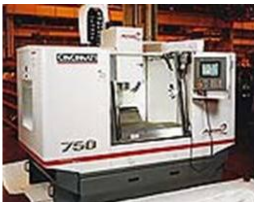
Рис. 3.12. Вертикальный обрабатывающий центр серии «ARROW-2», модели 750
