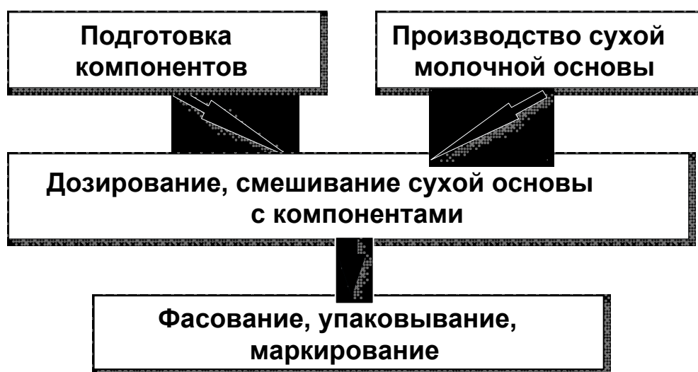
Рис. 1. Технологическая схема производства сухих заменителей
