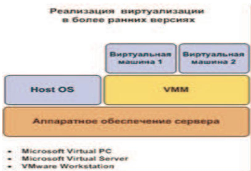
Рис. 8. Архитектура систем виртуализации более ранних версий.
