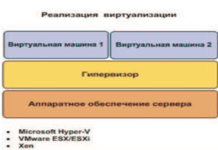
Рис. 9. Архитектура систем виртуализации на базе гипервизора.
