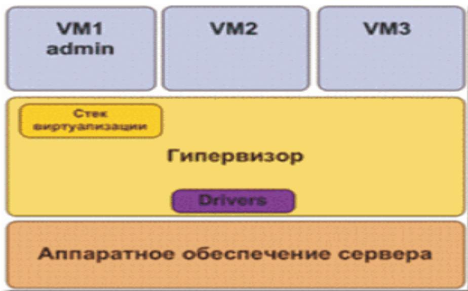
Рис. 10. Архитектура монолитного гипервизора.
