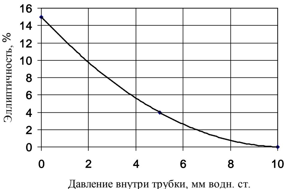
Рис. 2.5 Влияние давления внутри трубки в процессе коллапсирования на эллиптичность сердцевины.
