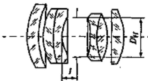
Технические характеристики объектива: фокусное расстояние 15 мм,  $l = 1.3$  мм,  $D_H = 5.16$  мм.
