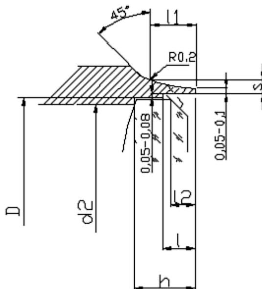
Рис. 1 Крепление линзы завальцовкой – размеры буртика
