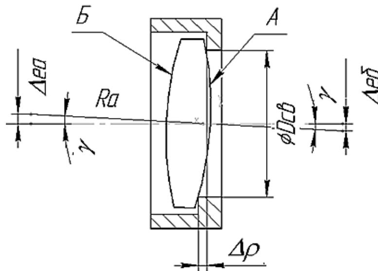
Рис. 4.5 Разворот линзы из-за неперпендикулярности опорного буртика базовой оси оправы
