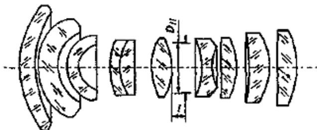
Технические характеристики объектива: фокусное расстояние – 20 мм,  $l = 0.9$  мм,  $D_H = 16.5$  мм.
