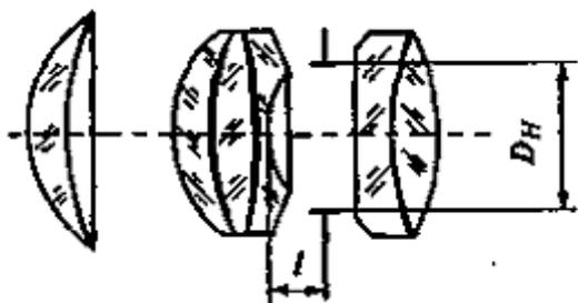
Технические характеристики объектива: фокусное расстояние 52.39 мм,  $l = 3,75$  мм,  $D_H = 16.7$  мм.
