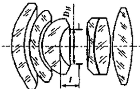
Технические характеристики объектива: фокусное расстояние объектива 53 мм,  $l = 44$  мм,  $D_H = 20.06$  мм.
