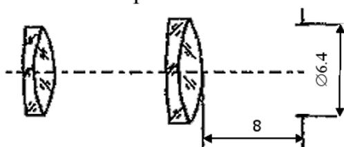
Технические характеристики объектива: длина тубуса 160 мм, фокусное расстояние 18 мм, рабочее расстояние 8.6 мм.
