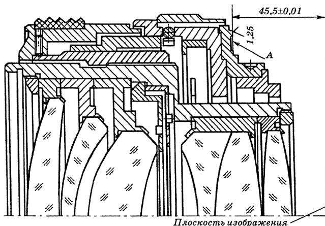
Рис. 1.6. Пример насыпной в оправе конструкции фотообъектива
