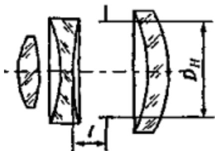
Технические характеристики объектива: фокусное расстояние 600 мм,  $l = 12.2$  мм,  $D_H = 44.8$  мм.
