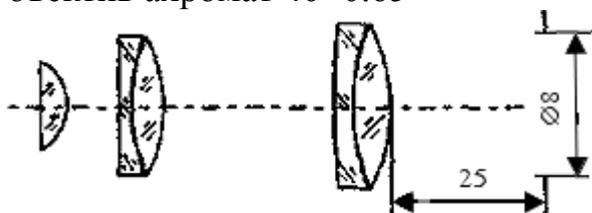
Технические характеристики объектива: длина тубуса 160 мм, фокусное расстояние 4.25 мм, рабочее расстояние 0.7 мм.
