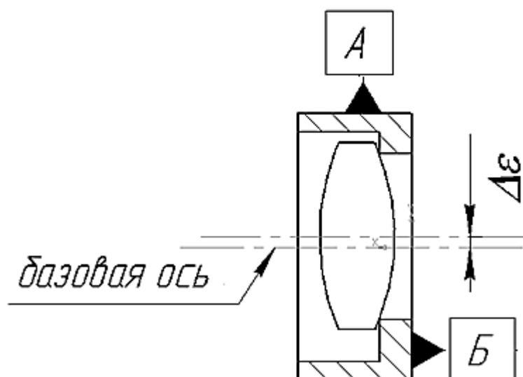
Рис. 4.6 Децентрировка линзы из-за эксцентриситета светового отверстия оправы
