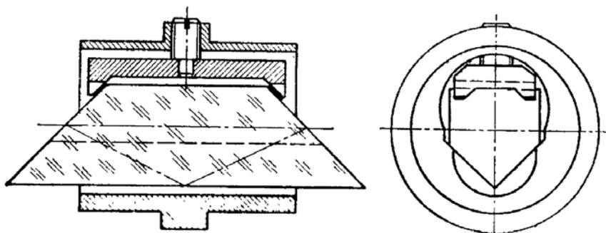
Рис. 1.11 Крепление призмы АКР-0 установочным винтом
