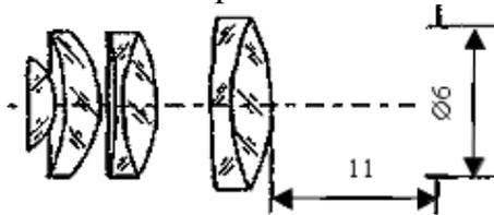
Технические характеристики объектива: длина тубуса 160 мм, фокусное расстояние объектива 1.96 мм, рабочее расстояние 0.1 мм.
