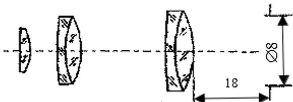
Технические характеристики объектива: длина тубуса 160 мм, фокусное расстояние 8.4 мм, рабочее расстояние 1.7 мм.
