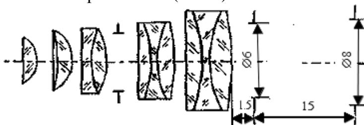
Технические характеристики объектива: длина тубуса 160 мм, диаметр ирисовой диафрагмы при  $A = 1$ ,  $D = 4.6$  мм, при  $A = 0.7$ ,  $D = 3.2$  мм.
