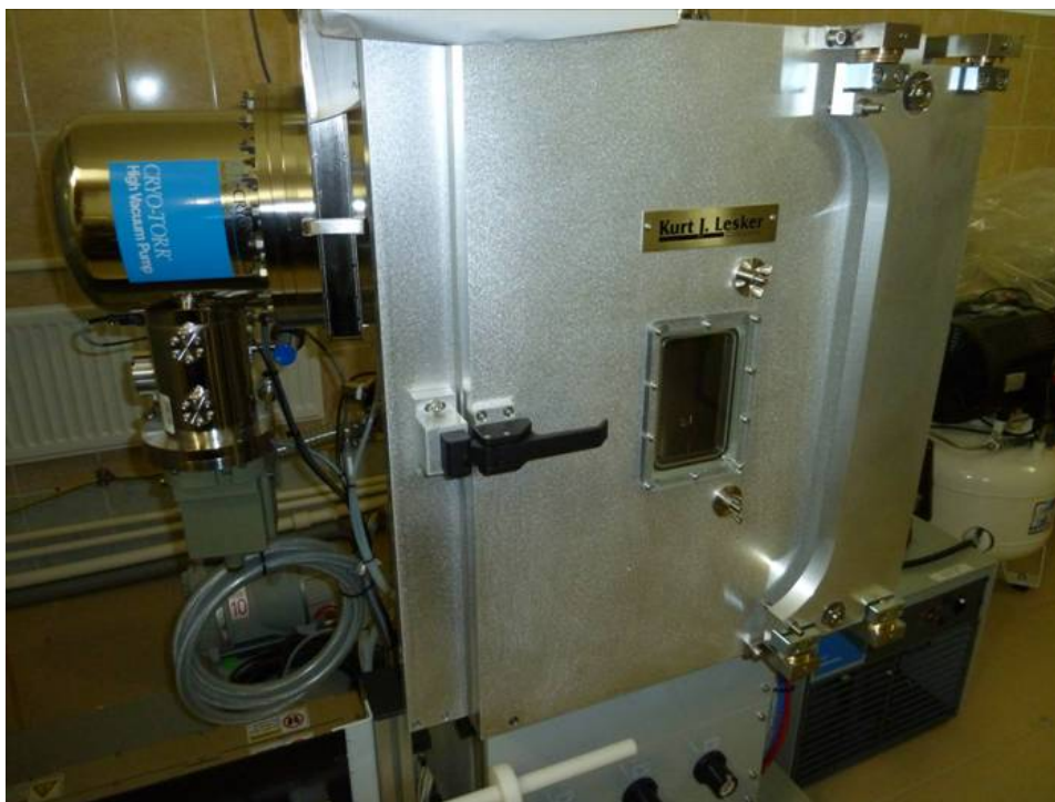
Рис. 35. Общий вид установки для нанесения тонких пленок методом физического напыления в вакууме. Криогенный насос обеспечивает создание безмасляного вакуума на уровне 10^{-7} торр. Конструкция вакуумной камеры включает два кварцевых окна, позволяющих облучать подложку в процессе нанесения слоев
