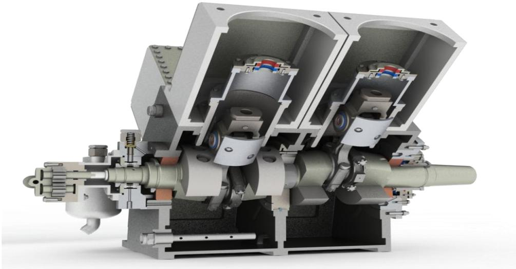
Рис. 9. База жидкостного детандера
