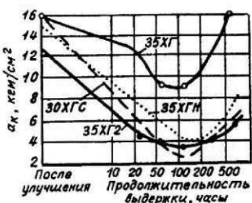
Рис. 178. Влияние продолжительности выдержки при  $500^{\circ}\text{C}$  на ударную вязкость
