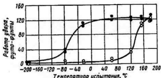
Рис. 177. Изменение ударной вязкости с температурой испытания у стали с 0,12% С, 0,5% Mn, 0,3% Si, 1,5% Cr и 3,5% Ni, производственные плавки:
