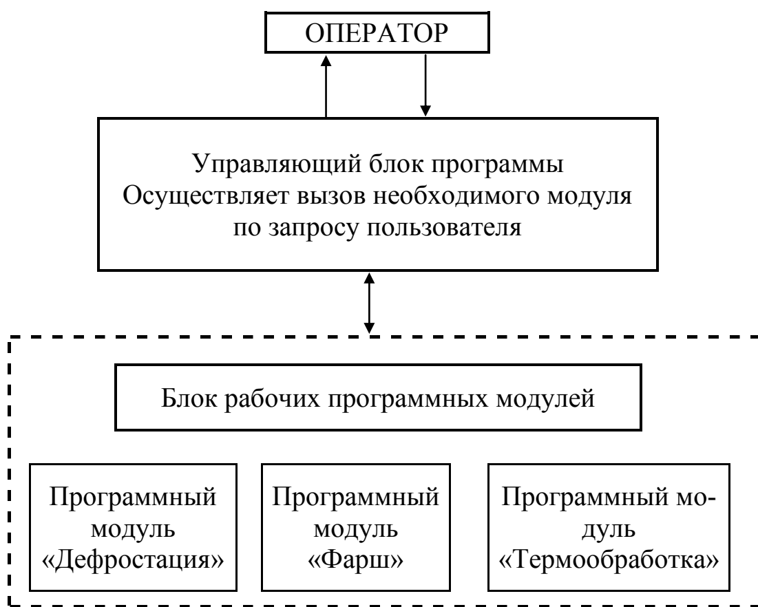
Рис. 3.2. Структура ПО АРМ Управляющий модуль ПО включает операторы 5-17. Модуль «Дефростация» включает операторы 25-810. Модуль «Фарш» включает операторы 1000-1840. Модуль «Термообработка» включает операторы 2000-2310.
