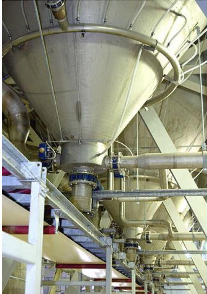
Рис. 11. Нижняя часть замочного аппарата
