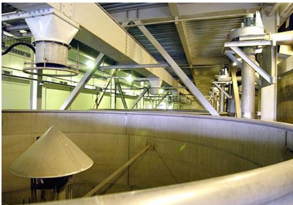
Рис. 10. Верхняя часть замочного аппарата
