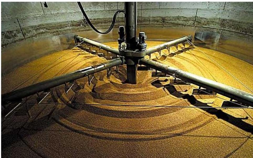
Рис. 14. Лопастные в замочном чане с плоским дном
