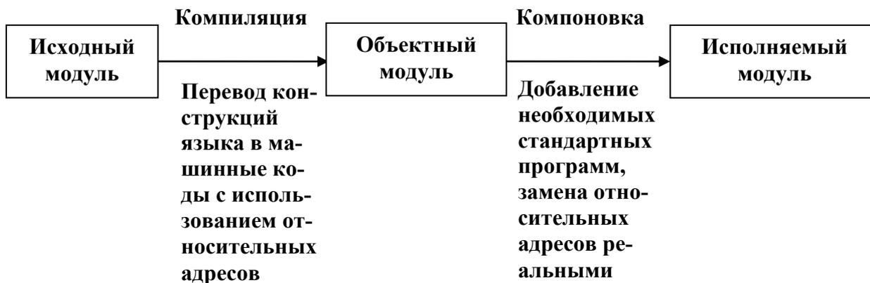
Рис. 4.1. Схема трансляции в режиме компиляции
