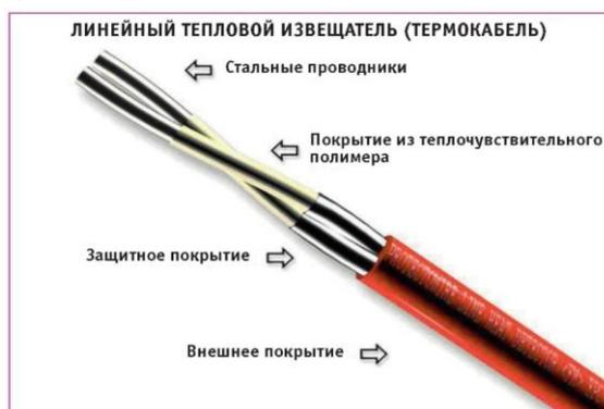
3. Линейный (термокабель). Существует несколько типов линейных тепловых пожарных извещателей:
