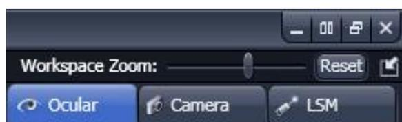
Кнопка «Ocular» изменяет путь луча микроскопа для непосредственного наблюдения через окуляры, лазеры блокируются
