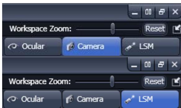
Кнопка «Camera» направляет луч микроскопа через порт с камерой
