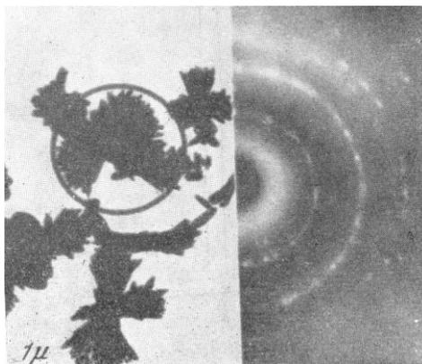
Рис. 2.7. Изображение монокристалла МоО и наложенная на него дифракционная картина от выбранной области.
