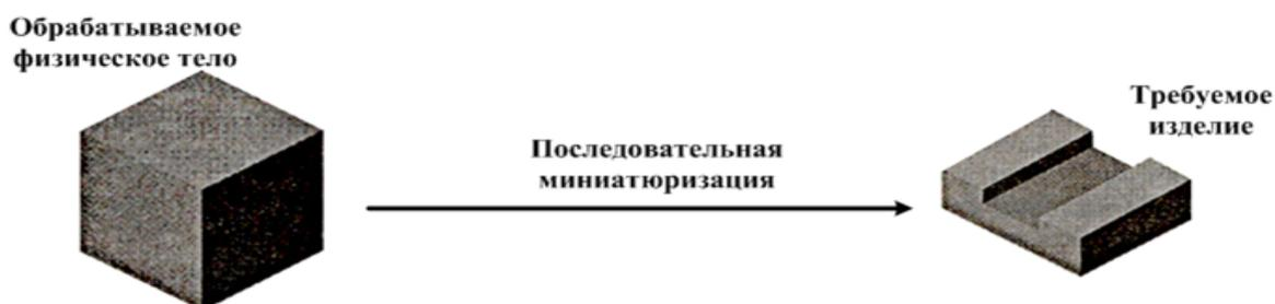
Рис. 1.11. Схематическое изображение подход **«сверху-вниз»** - обработки вещества с последовательным уменьшением размеров до нанометровых размеров [1.8].
