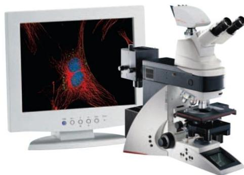
Рис. 5.6. Люминесцентный микроскоп Leica DM RXA2 фирмы Leica Microsystems.
