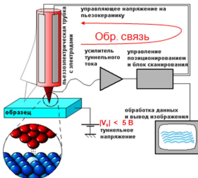
Рис. 1.20. Схема работы сканирующего туннельного микроскопа.
