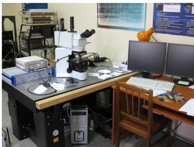
Рис. 9.3. Лазерный сканирующий люминесцентный микроспектрометр для измерения времен затухания люминесценции MicroTime100.
