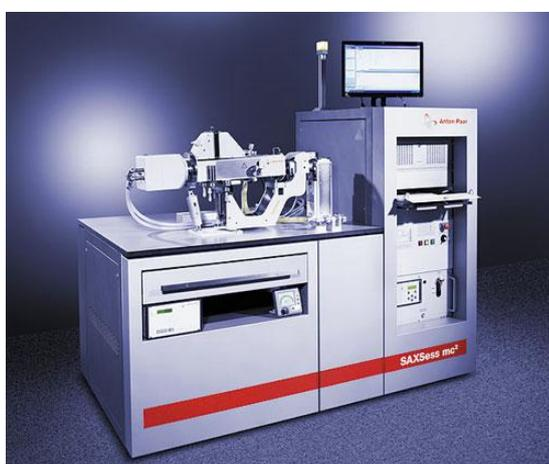
Рис. 1.24. Рентгеновская система для анализа наноструктур SAXSess  $\text{mc}^2$  фирмы Anton Paar.
