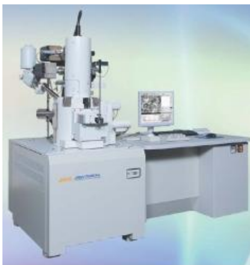
2.1.1. Растровый электронный микроскоп сверхвысокого разрешения JSM-7500F фирмы JEOL.
