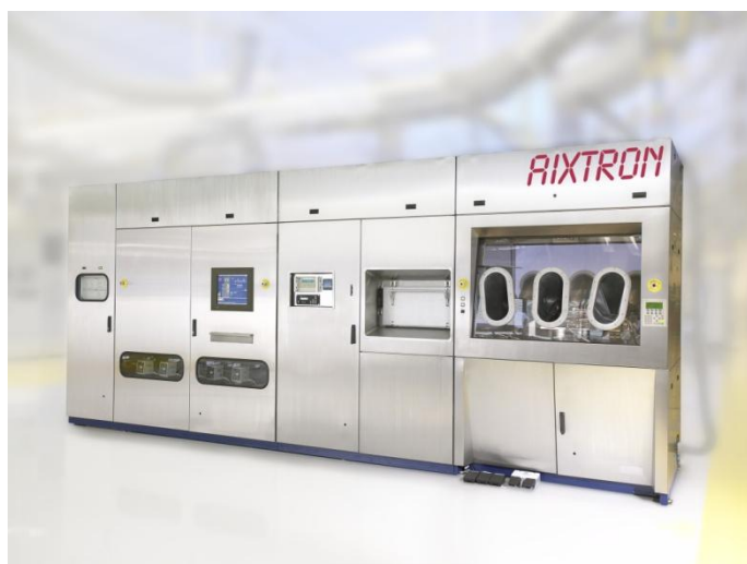
Рис. 1.2.2. Промышленная MOCVD установка фирмы AIXTRON.
