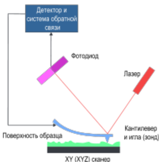
Рис. 2.2.2. Схема работы атомно-силового микроскопа.
