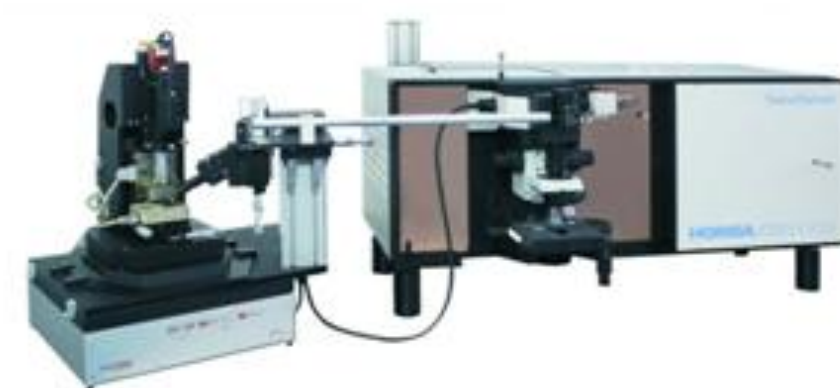
Рис. 2.4.1. Спектрометр LabRAM HR фирмы HORIBA, сконфигурированный для получения TERS сигналов.
