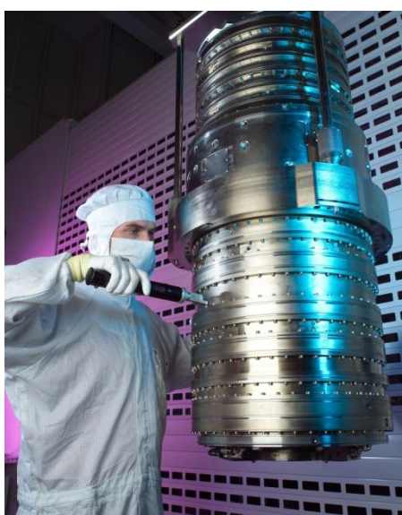
Рис. 1.3.2. Объектив Starlith®1700i, Carl Zeiss SMT [1.3.2], используемый в промышленной фотолитографической установке TWINSCAN XT:1700i фирмы ASML.
