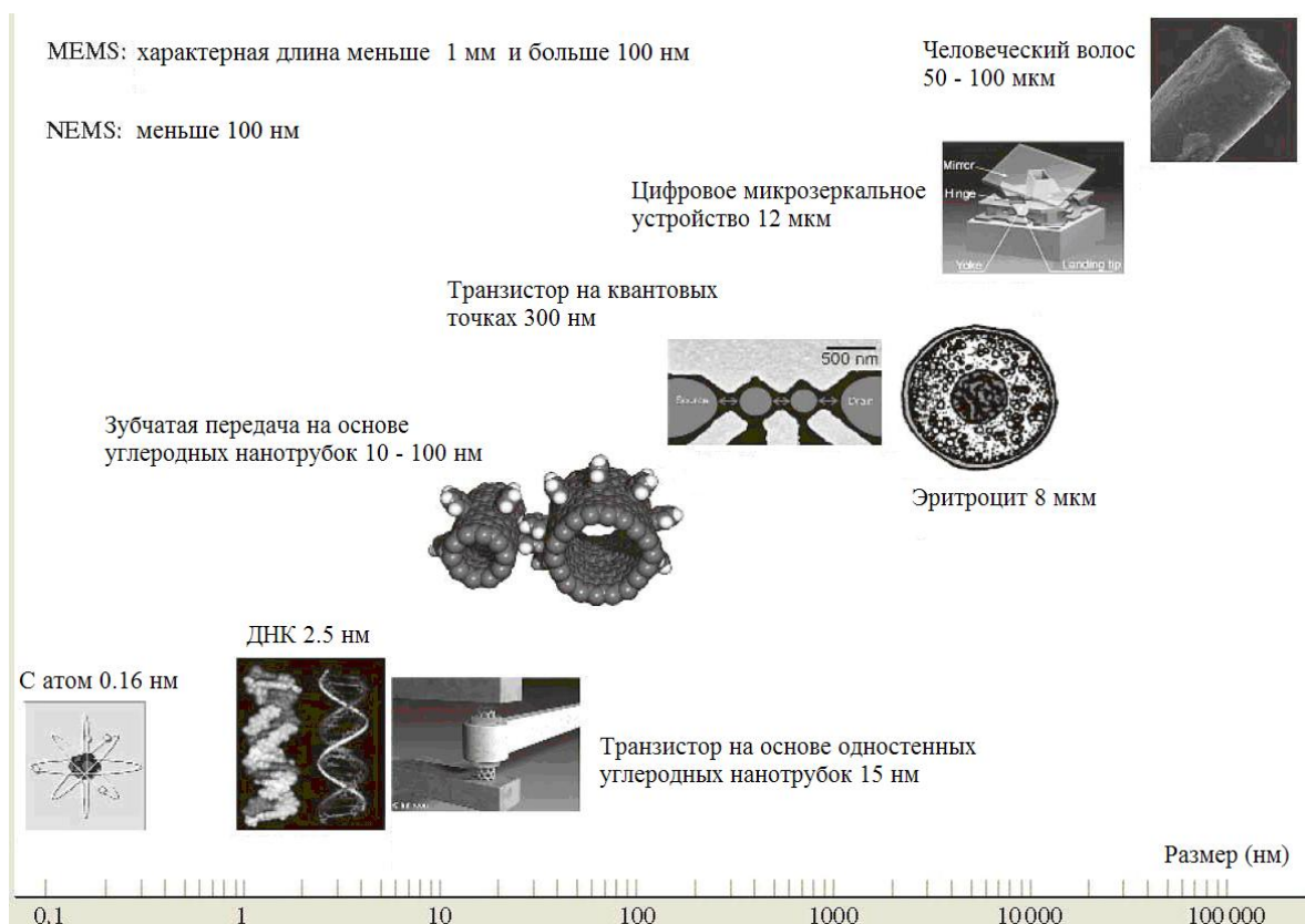
Рис. А.10. Иерархия размеров MEMS и NEMS в сравнении с человеческим волосом, эритроцитом, молекулой ДНК и атомом углерода [А.7].
