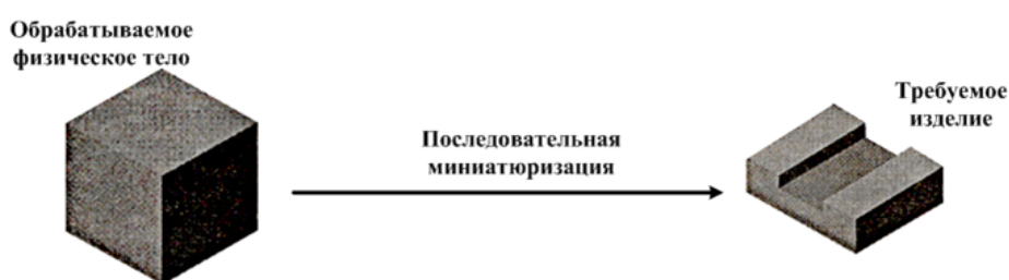
Рис. 1.1. Схематическое изображение подход «сверху-вниз» - обработки вещества с последовательным уменьшением размеров до нанометровых размеров [1].
