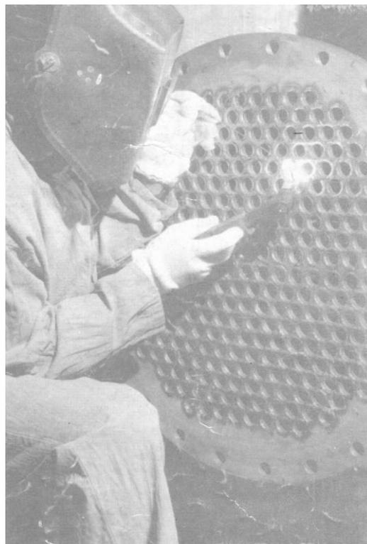
Теплообменные трубы: стальные бесшовные холоднодеформированные  $\varnothing 25 \times 2$  по ГОСТ 8734-78 из стали В10, В20 по ГОСТ 8733-74. Трубы свариваются с трубной решеткой аргонодуговой сваркой с последующей развальцовкой.
