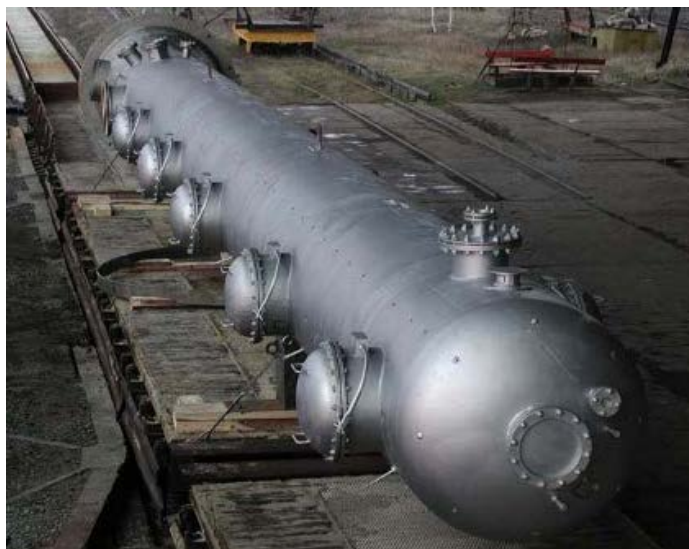
Рисунок 19 – Колонный массообменный аппарат с цельносварным корпусом в сборе
