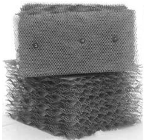
Рисунок 17 – Перекрестно-точная насадка фирмы Петон
