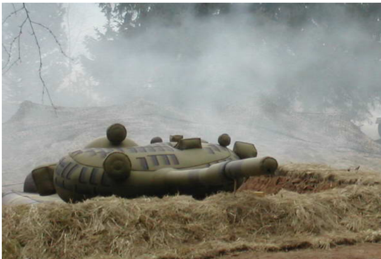
Макет танка в укрытии (работают имитаторы дымов).
