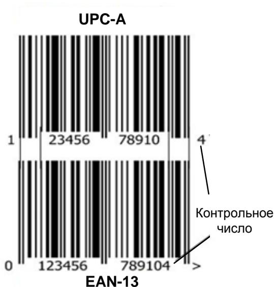
Рис. 1.5. Графические изображения штриховых кодов товаров UPC-A и EAN-13
