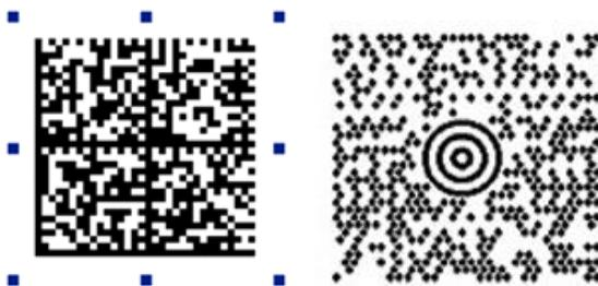
Рис. 2.2. Двумерные матричные штриховые коды Datamatrix и MaxiCode
