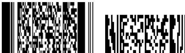
Рис. 2.1. Двумерные стековые штриховые коды PDF417 и MicroPDF
