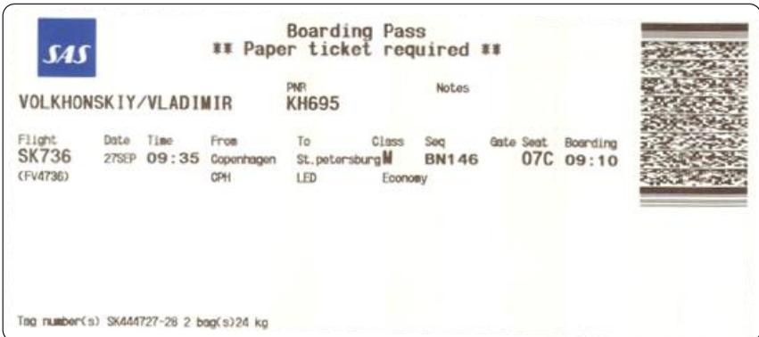
Рис. 2.4. Пример использования кода PDF417
