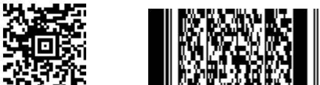
Рис. 1.2. Примеры двумерных штриховых кодов
