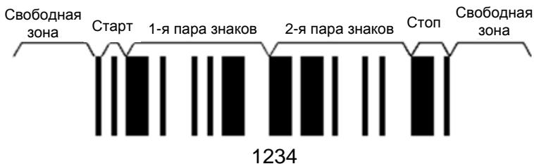
Рис. 1.13. Символ Interleaved 2 of 5, включая свободные зоны
