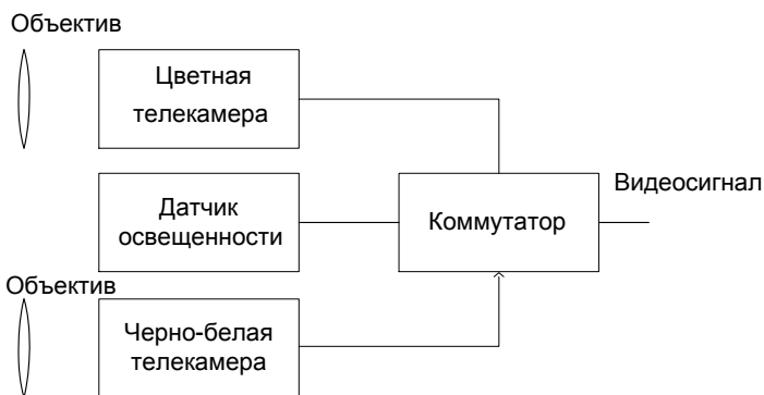
Рис. 4.1. Совмещение двух телекамер в одном корпусе
