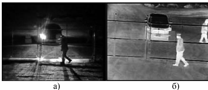
Рис. 4.10. Наблюдение с помощью ТВ-камеры (а) и тепловизора (б) при наличии встречной засветки
