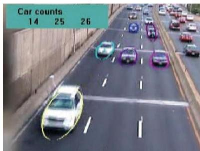
Рис. 4.2. Подсчет автомашин, движущихся по полосам
