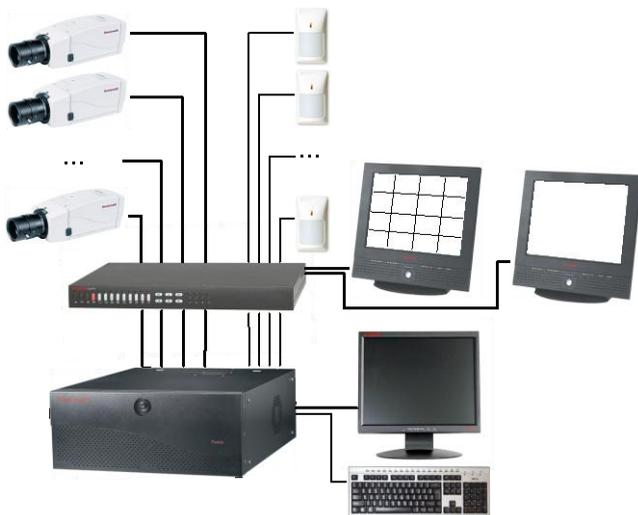
Рис. 3.16. ТВСН с цифровым многоканальным видеорегистратором и расширенными возможностями
