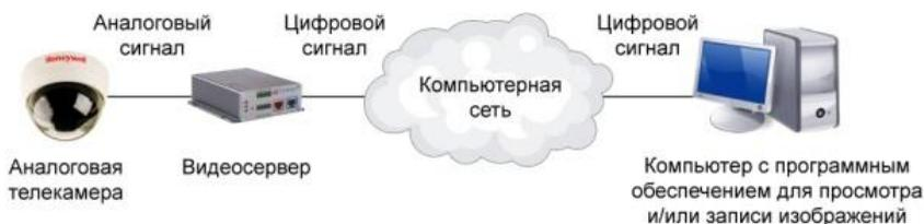
Рис. 3.23. Сетевая комбинированная система с сетевым видеосервером
