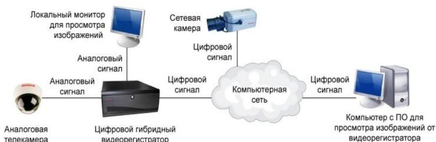
Рис. 3.24. Сетевая система с гибридным видеорежистратором
