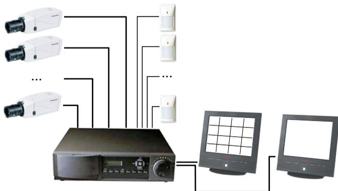
Рис. 3.15. ТВСН с цифровым многоканальным видеорегистратором
