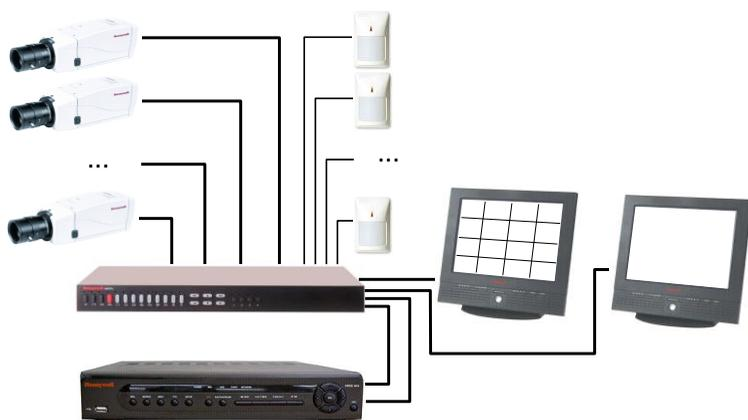
Рис. 3.14. ТВСН с мультиэкранным отображением и одноканальным видеореги­стратором
