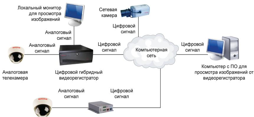
Рис. 3.25. Сетевая система с гибридным видеорегистратором и сервером
