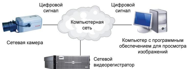
Рис. 3.28. Сетевая система с сетевым видеорегистратором
