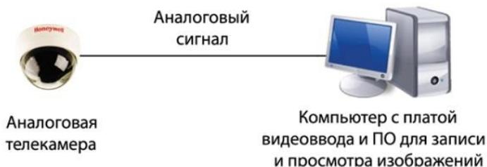
Рис. 3.21. Комбинированная система с цифровой записью на базе ПК
