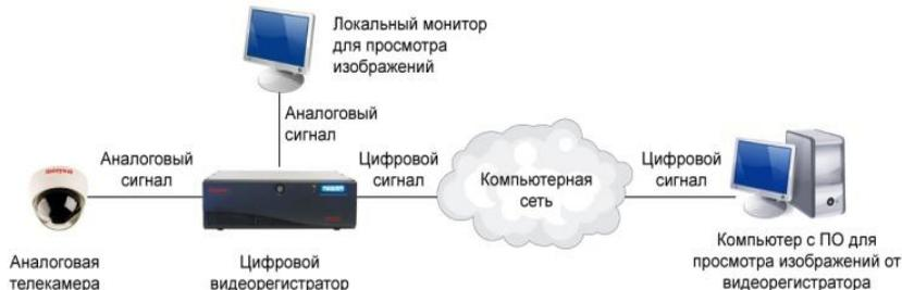
Рис. 3.22. Комбинированная сетевая система
