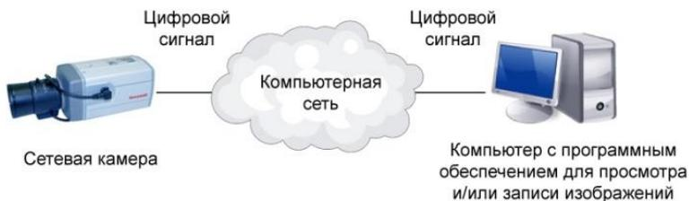
Рис. 3.27. Простейшая сетевая система
