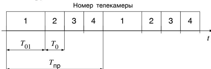
Рис. 3.6. Приоритетное по длительности отображение видеосигнала от одной из телекамер
