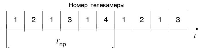
Рис. 3.7. Приоритетное по порядку отображение видеосигнала от одной из телекамер
