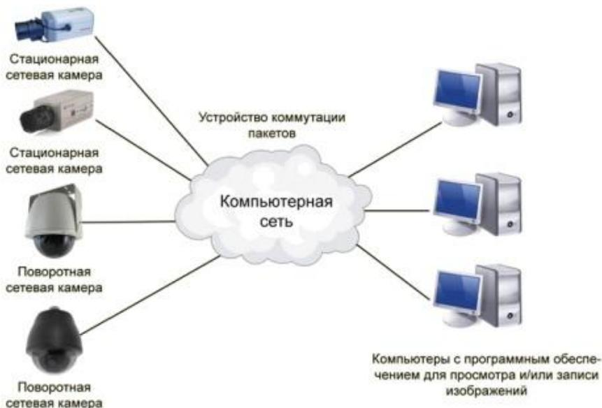
Рис. 3.30. Сетевая многопользовательская система
