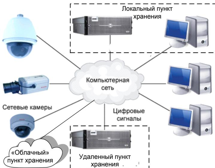
Рис. 3.32. Многопользовательская система с разделением пунктов просмотра и хранения видеоинформации
