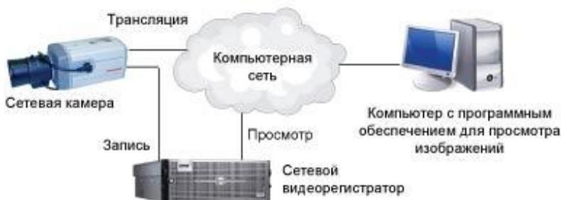
Рис. 3.29. Система с сетевым видеореги­стратором и раздельными каналами трансляции для просмотра реального видео и для видеозаписи
