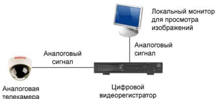
Рис. 3.20. Комбинированная система с аналоговым монитором и цифровой записью
