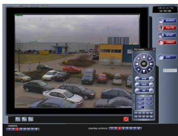
Рис. 3.3. Экранный пульт управления скоростью купольной телекамерой
