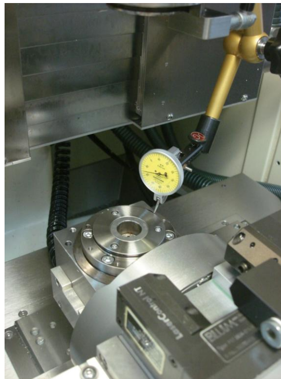
Рис. 18. Выставление соосности 3R-Center-plate по индикатору.
