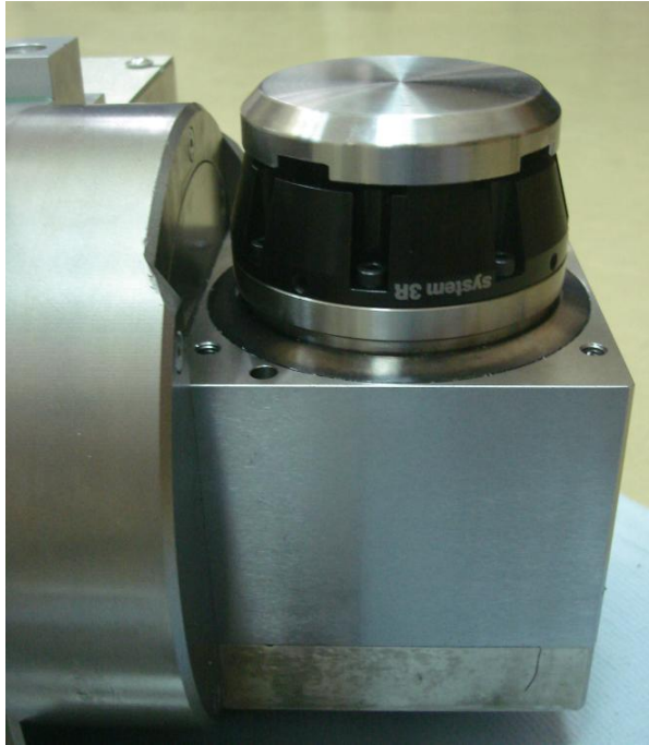
Рис. 47. Установленный пневматический патрон.
