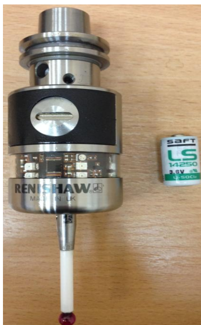
Рис. 58. Замена батареи измерительного щупа RENISHAW.
