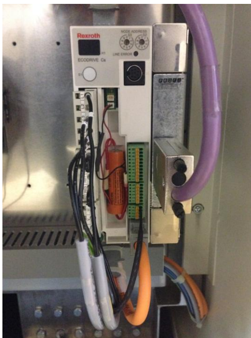
Рис. 57. Замена батареи сервопривода.
