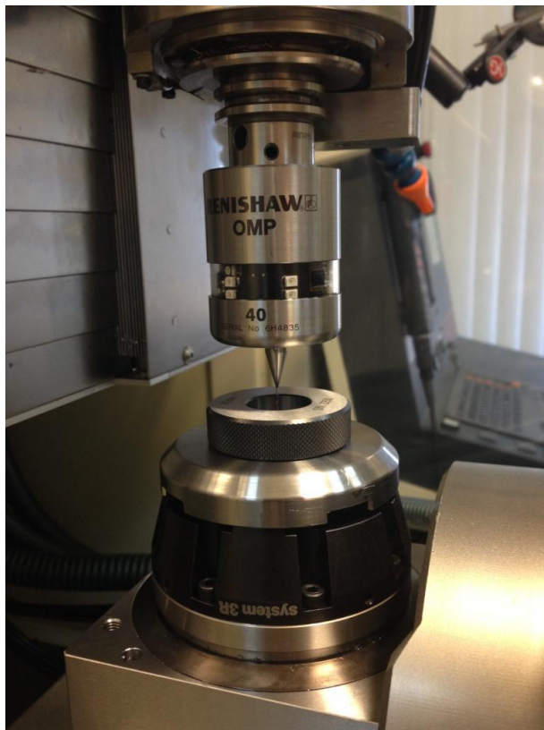
Рис. 31. Калибровка радиуса щупа.
