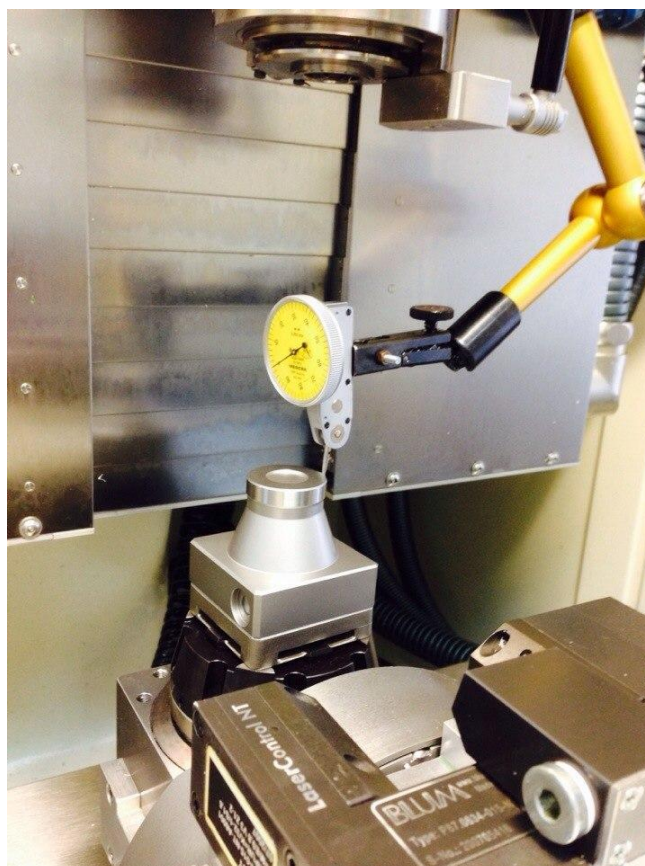
Рис. 24. Выставление System 3R 3R-656.1 соосно пневмопатрону.
