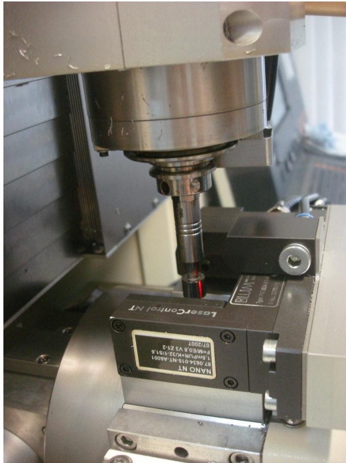
Рис. 28. Установка калибра в позицию измерения.
