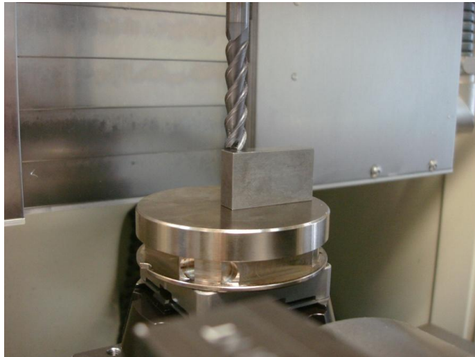
Рис. 29. Привязка заготовки через мерительную плитку.
