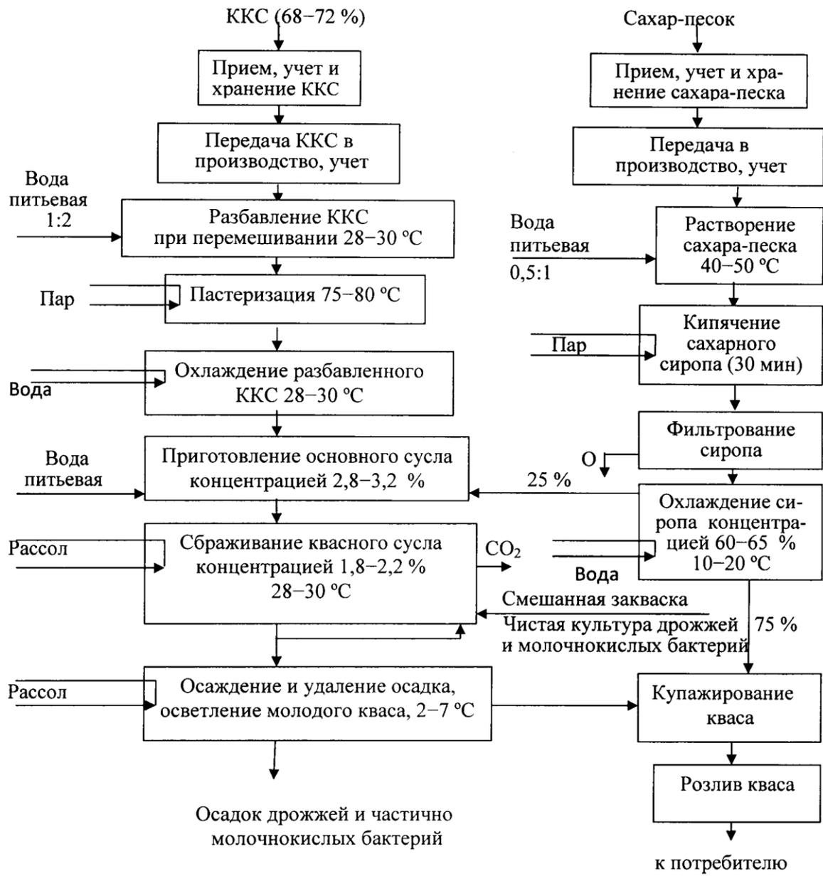
Рис. 1. Технологическая схема процесса производства кваса брожения
