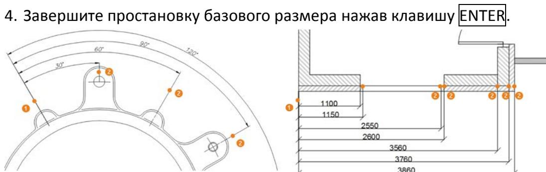
Рисунок 10.7 Установка базового размера
