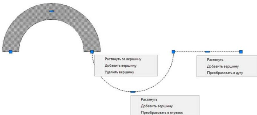
Рисунок 11.4 Редактирование полилинии с помощью многофункциональных ручек
