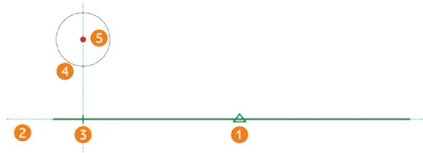
Рисунок 6.4 Использование привязки «Точка отслеживания» для задания центра окружности
