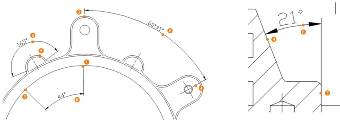
Рисунок 10.6 Установка угловых размеров
