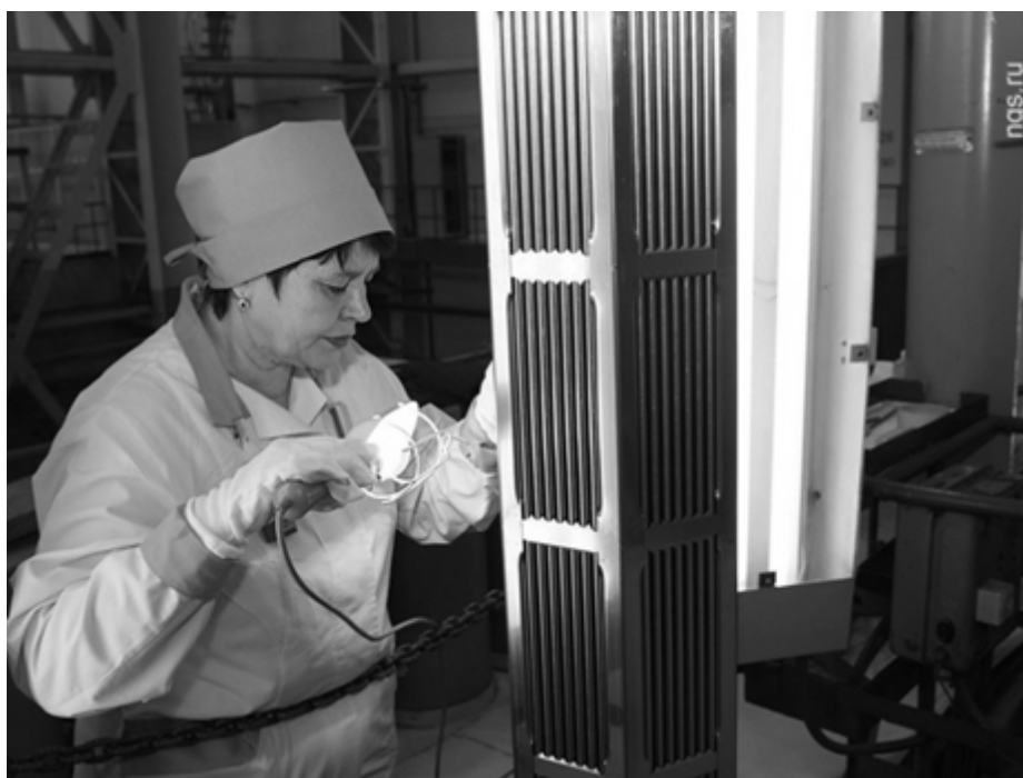
Рисунок 2.36 - Контроль качества готовых ТВС
