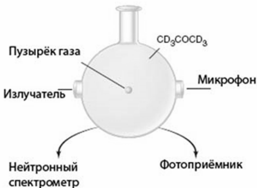
Рисунок 2.27 – Схема установки Талейярхана (иллюстрация с сайта inventors.about.com ).
