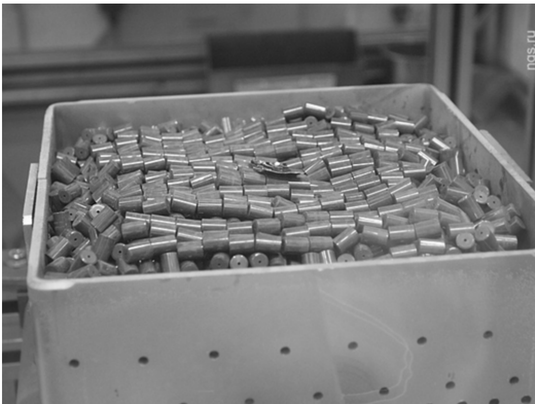
Рисунок 2.31 – Молибденовый контейнер «лодочка» с таблетками отправляют в печь на высокотемпературный отжиг (спекание).
