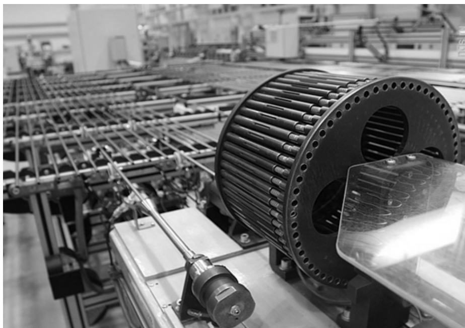
Рисунок 2.34 – Заполнение циркониевых трубок ТВЭЛ
