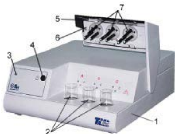
Рисунок 3.6.1 - Внешний вид жидкостного вольтамперометрического анализатора «ТА-Lab»: 1 – корпус, 2 – кварцевые стаканчики для проб, 3 – индикатор сети, 4 – кнопка управления подъемом электродов, 5 – крышка, 6 – кронштейн для установки электродов, 7 – электроды.
