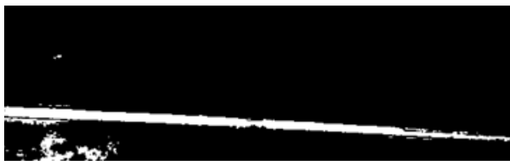
Рис. 1.7. Результат локальной пороговой обработки
