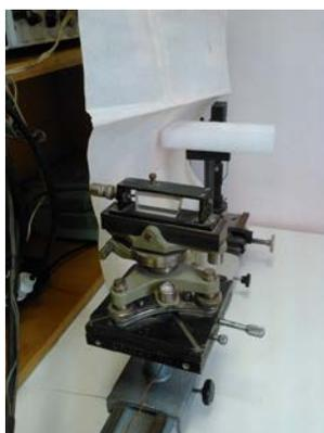
Фото 6. Электромеханический модулятор.
