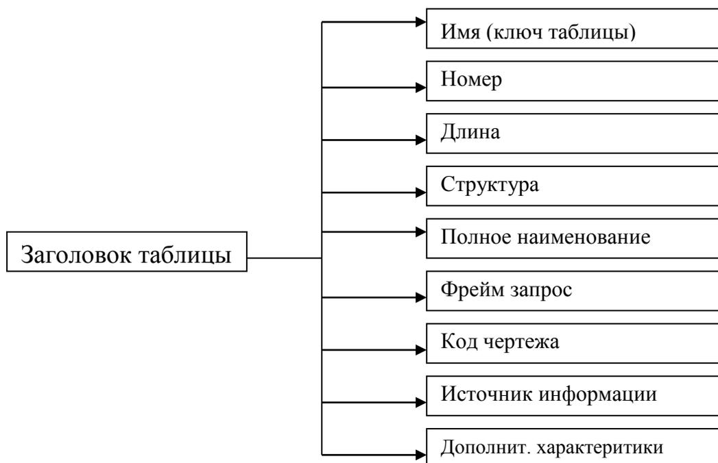
Рис. 4.3. Структура заголовка таблицы в ИПС "Режущий инструмент"
