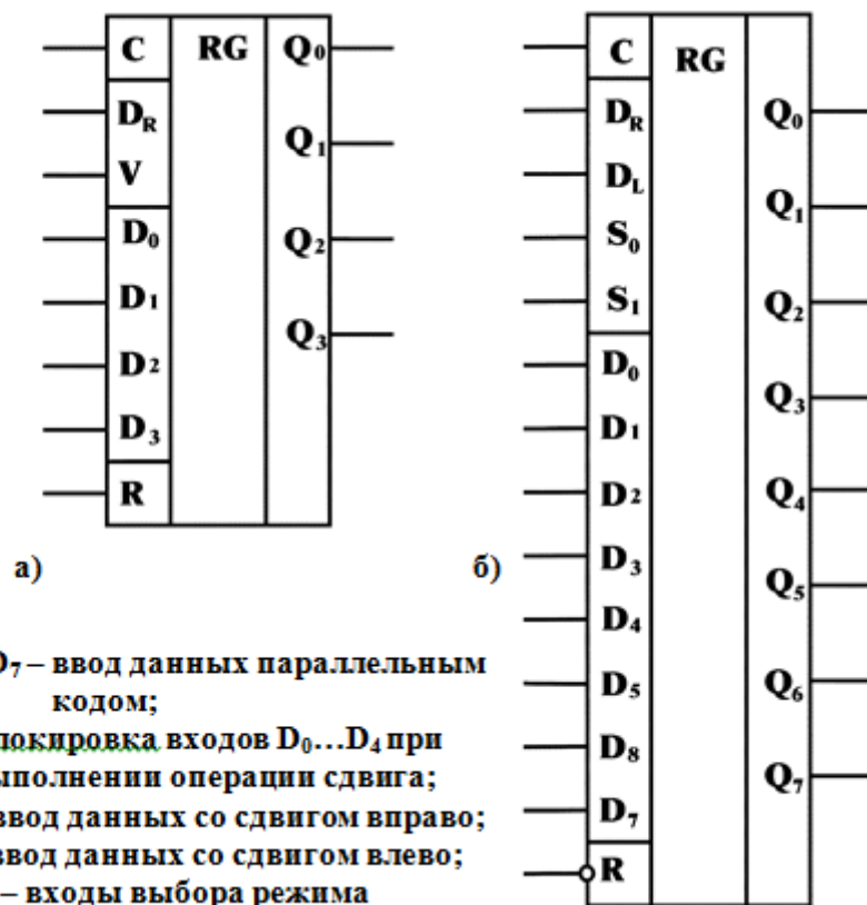
Рисунок 2.24 – Функциональное обозначение четырёхразрядного регистра сдвига (а); универсального восьмиразрядного регистра сдвига (б)
