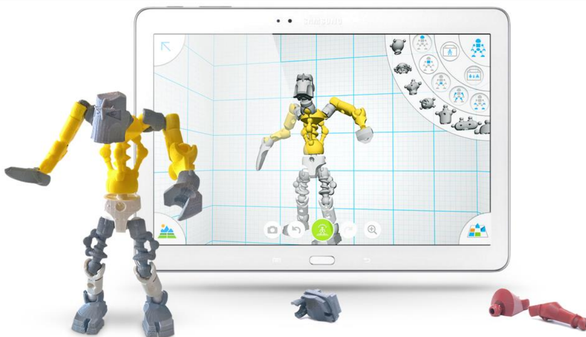
Рисунок 2.6. Моделирование изделия в системе Tinkerplay на планшетном компьютере и результаты трехмерной печати модели
