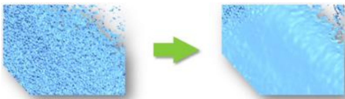
Рисунок 1.14. Сглаживание шумов на полигональной модели
