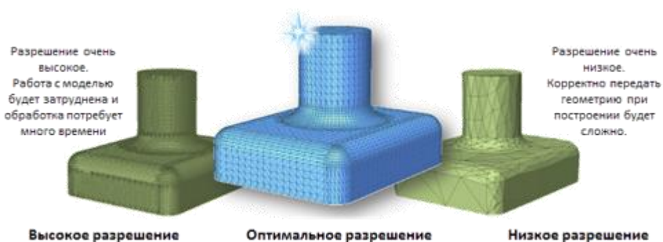
Рисунок 1.15. Оптимизация моделей на основе сочетания двух видов сеток
