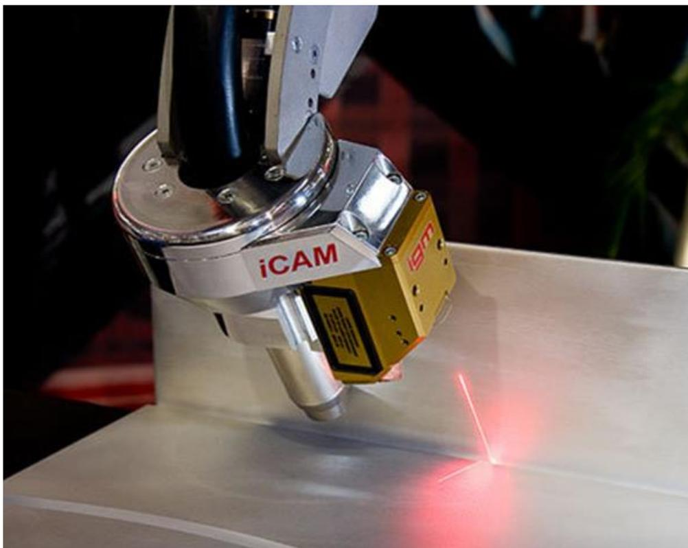
Рисунок 4.3. Поиск области сварки с помощью лазерного сканера
