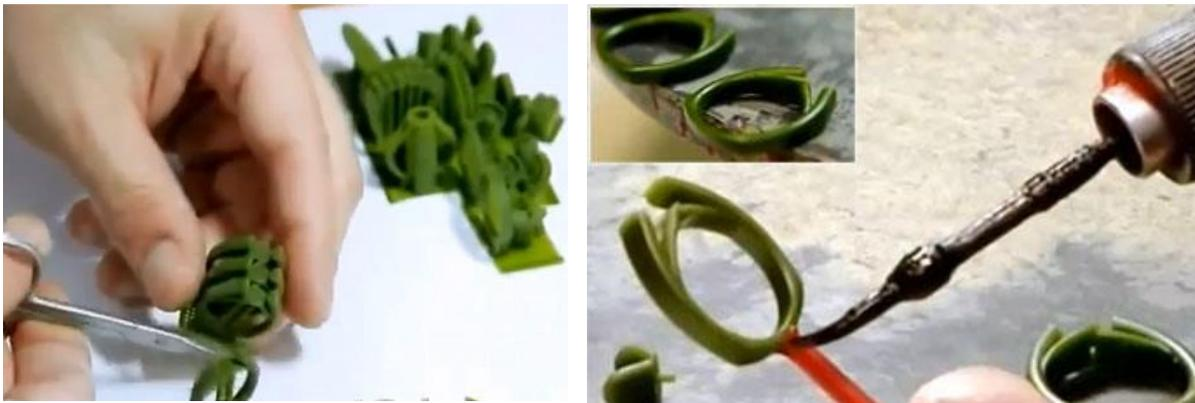
Рисунок 1.6. Разделение набора деталей и добавление к ним вспомогательных ножек
