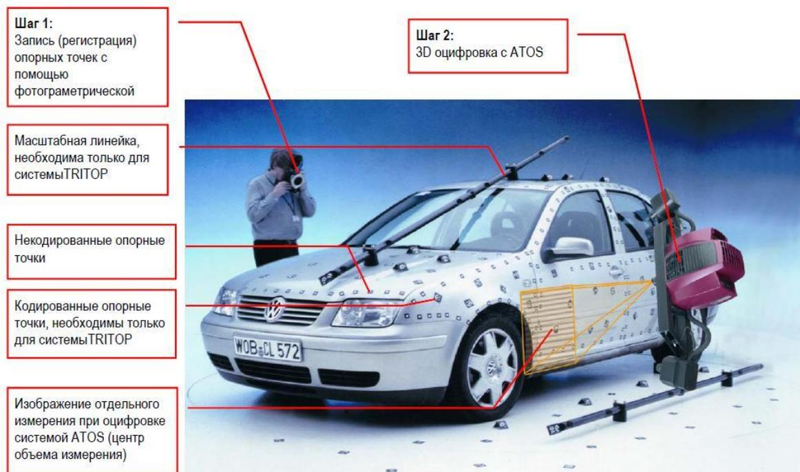
Рисунок 4.22. Сканирование автомобиля с использованием системы TRITOP
