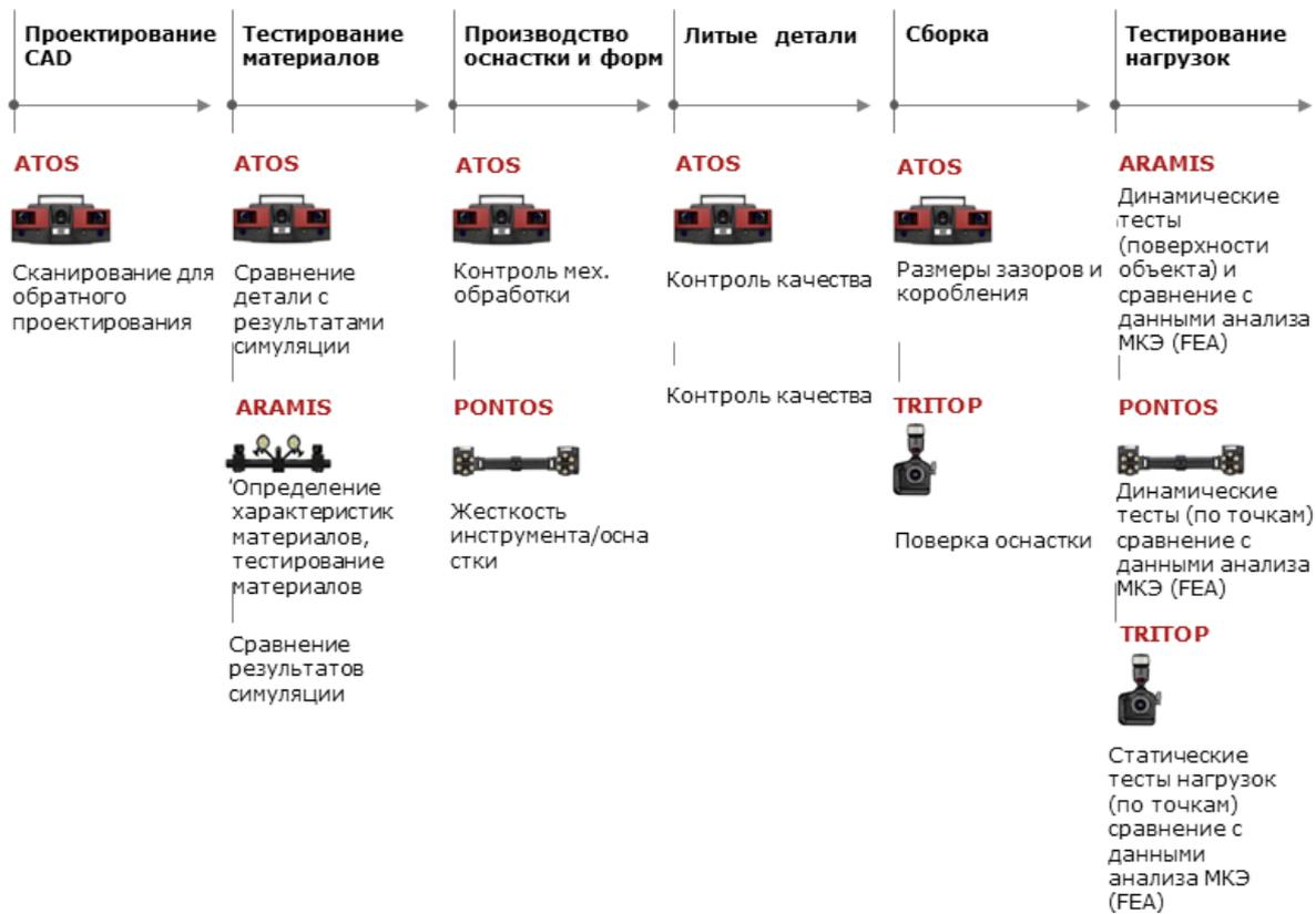
Рисунок 4.18. Задачи, решаемые измерительными системами компании GOM
