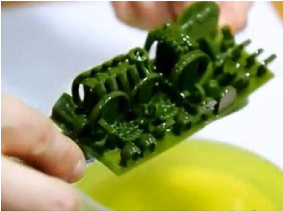
Рисунок 1.5. Обработка прототипа, полученного на трехмерном принтере Envisiontech
