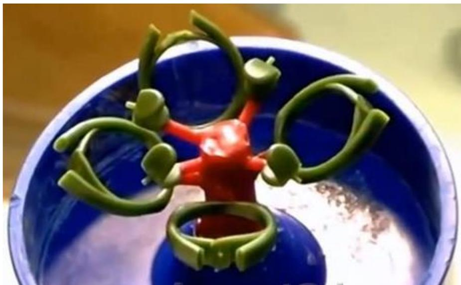
Рисунок 1.7. Заготовка для литья соединенная с центральным литником
