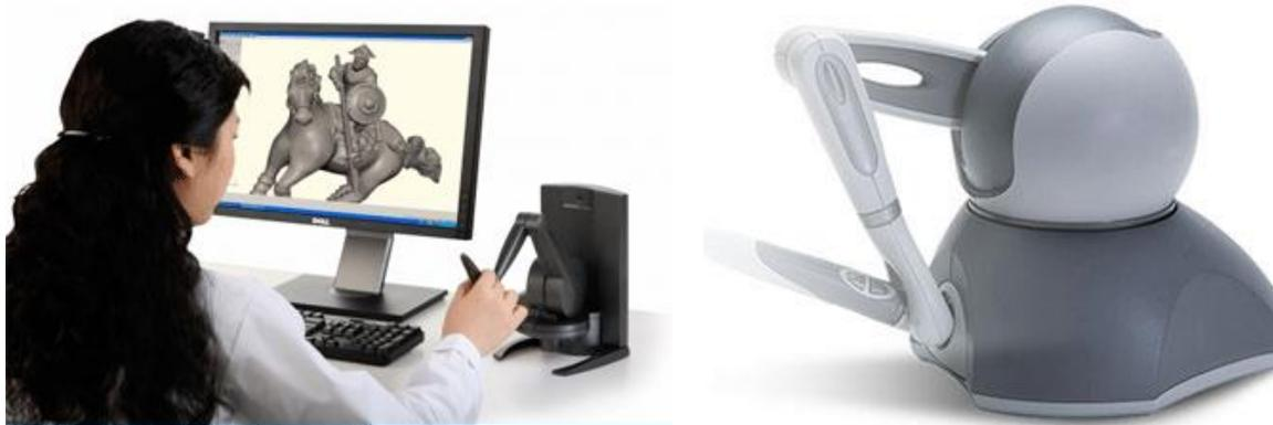
Рисунок 1.2. Специализированный манипулятор для скульптурного моделирования Geomagic Touch X
