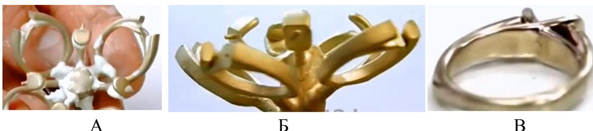
Рисунок 1.8. Набор изделий, полученных из разрушенной формы (А), очищенных (Б) и разделенных на элементы с последующей доработкой (В)
