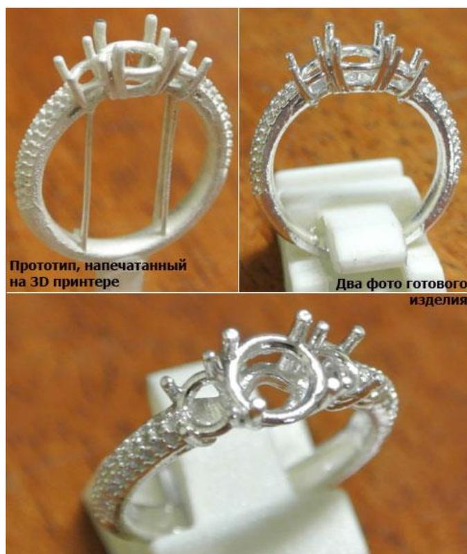
Рисунок 1.1. Прототип, напечатанный на специализированном трехмерном принтере, и результат литья ювелирного изделия по этому прототипу
