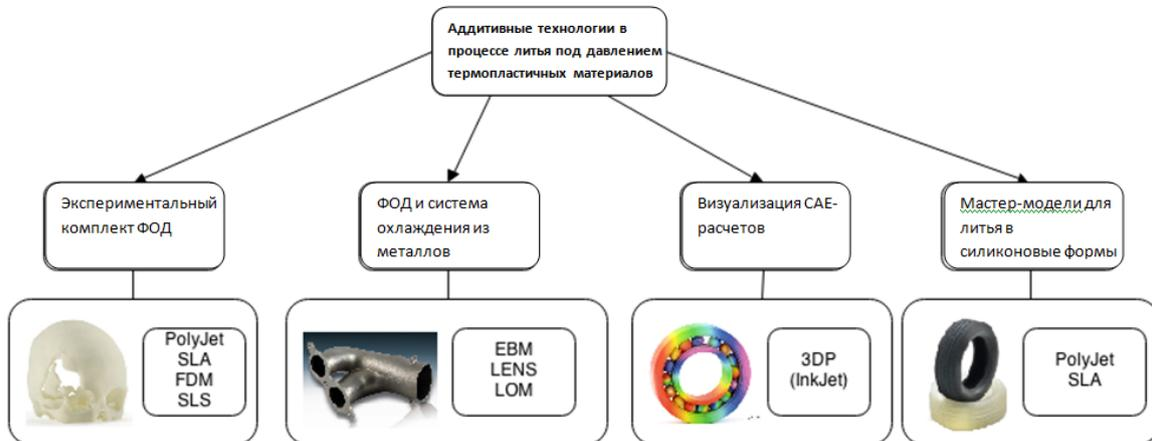
Рисунок 1.9. Классификация аддитивных технологий при подготовке производства изделий из термопластичных материалов
