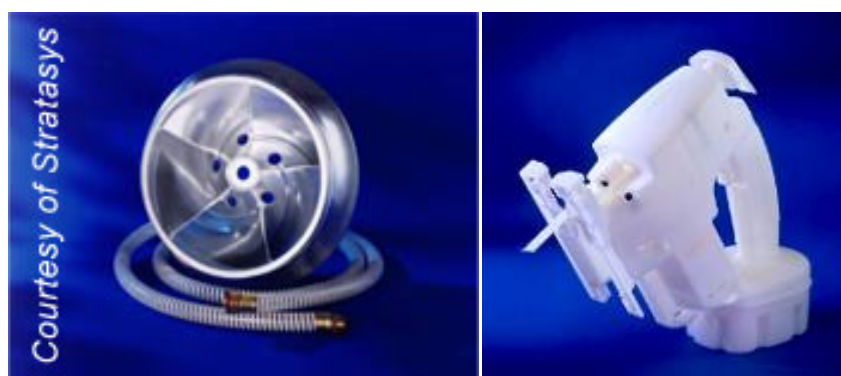
Рисунок 1.16 – Сложное изделие с импеллером и модель электроробзика, созданные при помощи технологии FDM
