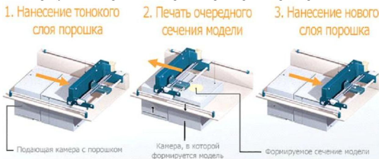
Рисунок 1.21 – Принцип работы 3D принтера.
