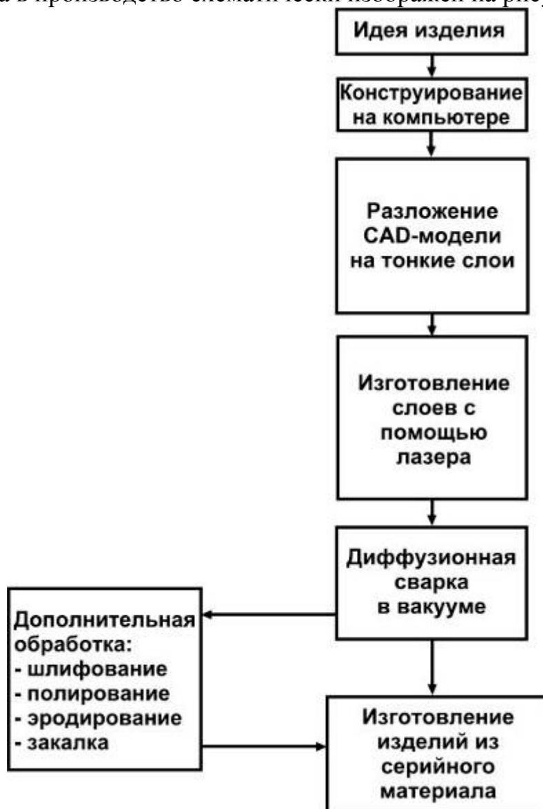
Рисунок 1.37 – Схема процесса создания пресс-форм из металлов
