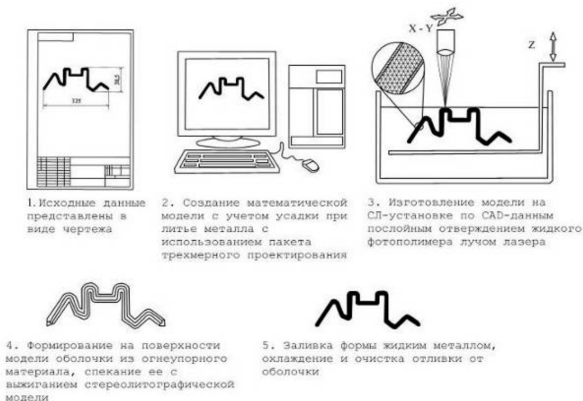
Рисунок 1.34 – Схема технологического процесса литья по выжигаемым моделям
