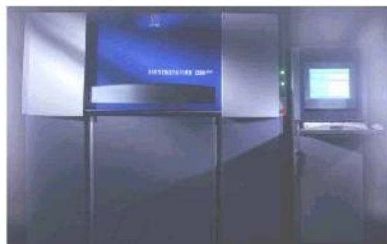
Рисунок 1.8 – SLS-установки: а) Sinterstation 2500; б) Sinterstation 2500Plus
