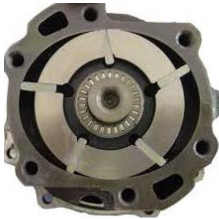
Рисунок 13 – Вид пластинчатого насоса со снятой крышкой
