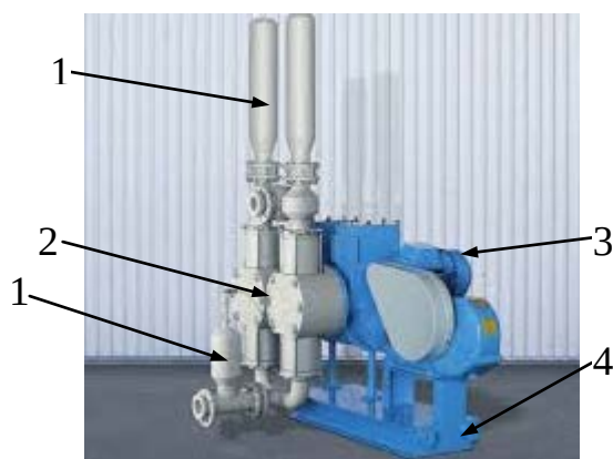
1 – воздушные колпаки (демпферы), 2 – рабочие цилиндры, 3 – электродвигатель, 4 – станина
