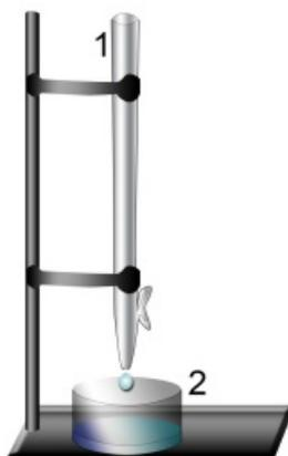
Рисунок 7.3 – Схема установки для определения поверхностного натяжения.
